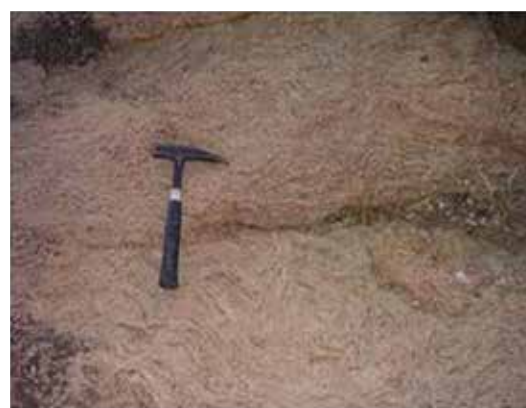
Foto 5.2 – Afloramento de biotita gnaisses sienogranítico, mostrando a estrutura gnáissica algo migmatizada evidenciada por uma foliação marcada por níveis descontínuos de biotita. Ortognaisse Serra das Flores (afloramento VM-178)
