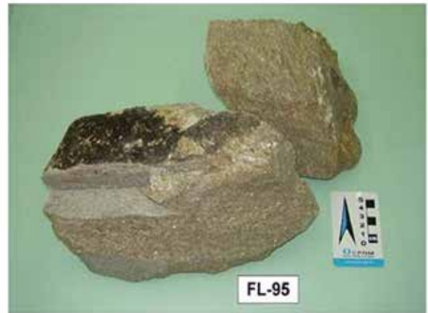
Foto 5.11 – Amostra de leucogranitóide granodiorítico/tonalítico a duas micas, exibindo textura equigranular média e foliação. Sheet de leucogranitóide sintectônico nos paragnaisses migmatíticos do Complexo Araticum (amostra FL-95).
