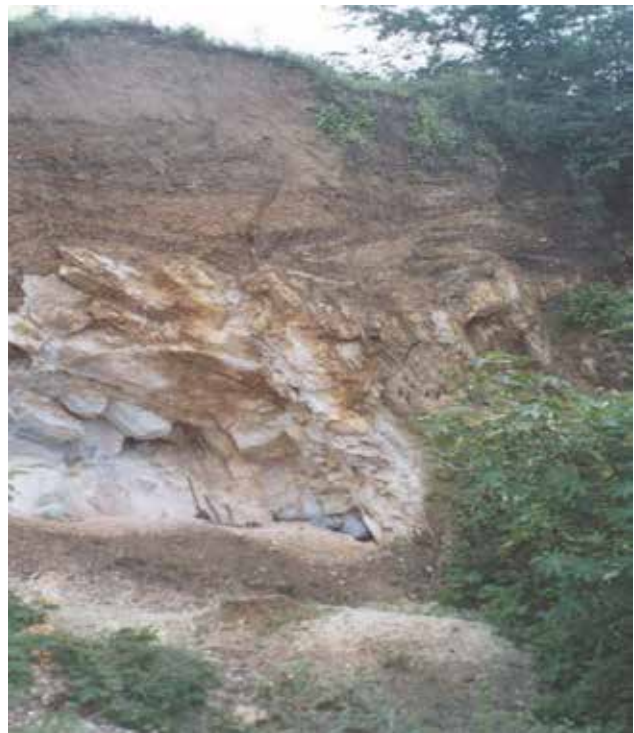
Foto 9.27 – Uma das várias frentes de lavra da Mineração Coruripe da Cal (md 54). As camadas de mármore dolomítico são alcançadas por escavações, mostrando a cobertura de solo formado às expensas das rochas carbonatadas. As camadas acham-se dobradas, apresentam mergulho forte, com orientação local de N 550 E alinhadas com o trend regional.
