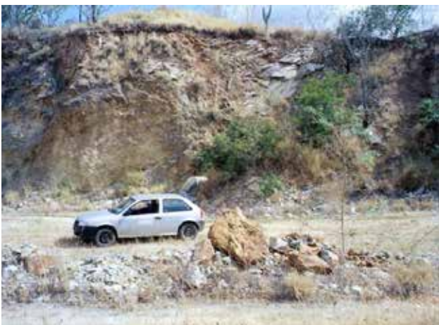
Foto 9.55 – Mina Campestre - frente de exploração de asbesto antofilítico e de biotita xisto encaixante. Município de Jaramataia - AL.
