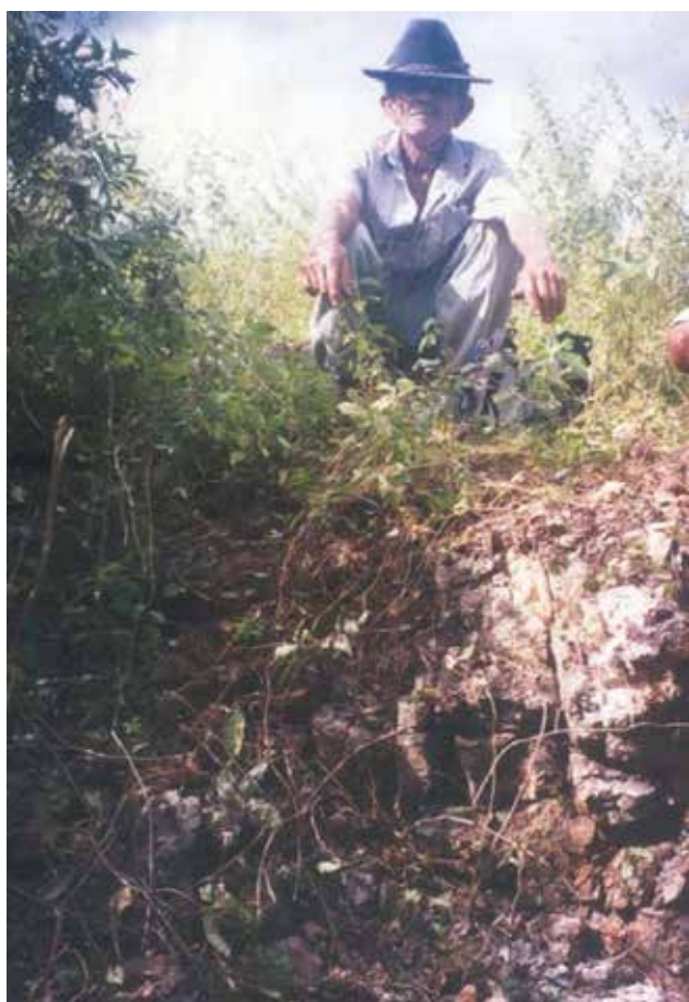
Foto 9.31 – Vista parcial de uma vala com 50m de extensão, 2m de largura e 2m de profundidade tomada pela cobertura vegetal e solo. Vê-se a presença da parede constituída por minerais de feldspatos. Escavação antiga destinada à exploração de água-marinha, cristal-de-rocha e muscovita. Garimpo Durval Moço (Riacho Seco). Limoeiro de Anadia - AL.
