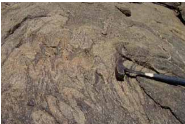
Foto 3.10 – Sillimanita - granada - biotita gnaiss migmatítico, dobrado. Complexo Arapiraca. (Afloramento VM - 452).
