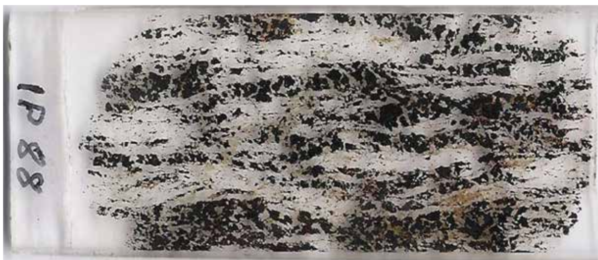
Foto 9.4 – Imagem da lâmina completa, com altura (largura da lâmina) de 26mm, mostrando bandamento cíclico dado por alternância de bandas ricas em opacos (pretos) e anfibólios (marron esverdeado claro) e bandas leucocráticas, com quartzo (incolor) dominante e inclusões finas de opacos indicando uma pretérita laminação submilimétrica (até 5 ciclos) por banda.
