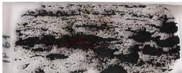
Foto 9.8 – Visão geral da lâmina delgada polida (altura = largura da lâmina = 26mm) mostrando as manchas escuras centimétricas de opacos em agregados sob forma de mosaico poligonal (magnetita martitizada). As manchas apresentam formas variadas, desde lentes alinhadas, tendendo a formar uma banda, a arredondadas isométricas, sem alinhamento. Os contornos das manchas, sempre com embainhamentos ou apófises em relação à matriz, esta formada por um mosaico milimétrico de quartzo poiquiloblástico rico em inclusões submilimétricas de opacos (magnetita), ora alinhados segundo uma laminação submilimétrica descontínua, mas por vezes ciclicamente repetida.
