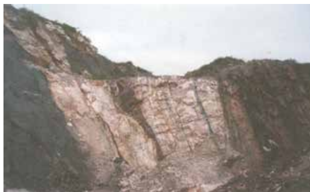
Foto 9.24 – Uma das frentes de lavra da Mina Porto da Folha (28 md), da MIBASA, mostrando o corte de lavra transversal na lente de mármore branco, dolomítico, intercalada em quartzitos rosados na capa e xistos pretos na lapa. Têm-se variações composicionais internas com espessuras e composições não determinadas. Espessura de 15 metros e atitude 85 NW; 75 NE. Município de Porto da Folha - SE, Serra da Laje.
