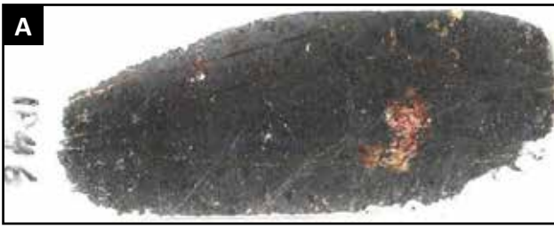
Foto 9.15.A – Vista integral da lâmina polida, apresentando minério em mosaico de opacos maciço com uma mancha de agregado de silicatos (marrom esverdeada) e alguns grãos isolados, e finas fraturas diagonais. A observação mais acurada da massa opaca permite distinguir grãos mais escuros (pretos = espinélio) numa massa cinza escura (martita e ilmenita). Altura = 26mm.
