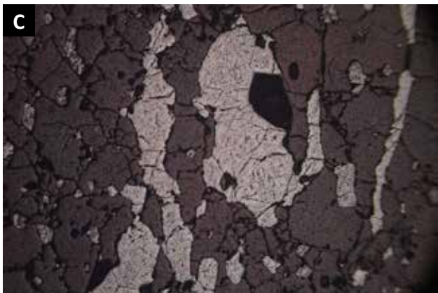
Foto 9.9.C – Mesma área vista em A e B, agora sob luz refletida, mostrando que a lente de magnetita (cinza clara) é formada por vários grãos de forma poligonal e não de um único fenoblasto. Largura 3,0mm.
