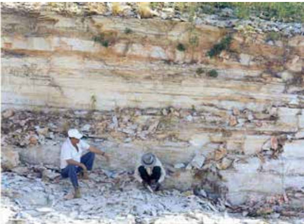
Foto 9.48 – Frente de exploração manual do quartzito branco no Sítio Olho d'Água, município de Porto da Folha - SE.
