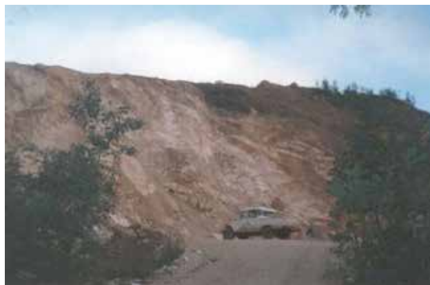
Foto 9.23 – Uma das frentes de lavra da MIBASA, na localidade de Serra do Boqueirão (40 md), onde o mármore dolomítico para corretivo de solo é desmontado e transportado para as instalações de beneficiamento, situadas a poucos metros. Belo Monte - AL.
