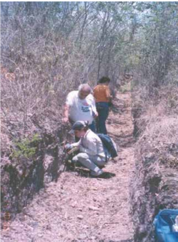
Foto 9.20 – Uma das trincheiras transversais, de direção L-W, da pesquisa efetuada pela CPRM/CODISE, cortando o perfil de solo e a sequência de rochas parcialmente alteradas, reveladas como xistos biotíticos, quartzitos e mármore. Alvo Fazenda Júlia, município de Porto da Folha - SE.
