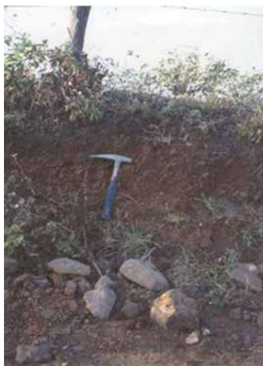
Foto 9.3 Plaquetas de minério de ferro (jacutinga), compondo o saprólito. Acima, o solum. A alteração, no corte raso da estrada revela a presença do ferro bandado in situ. Veados/Belo Horizonte (78 Fe-b), Traipu - AL.
