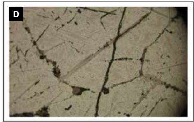
Foto 9.15.D – Inseto do retângulo menor em A), mostrando em detalhe a lamela de exsolução maior de ilmenita (cinza acastanhada, diagonal NE) e os contornos do grão de magnetita sublinhados pelos rosários como descritos em B. Largura 0,8mm
