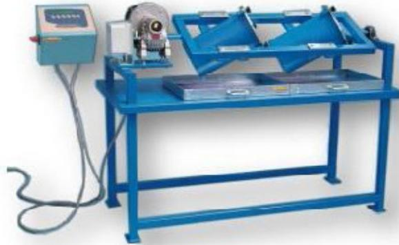
Figura 3.14 - Equipamento utilizado no Ensaio Micro-Deval. (Dias Filho, 2012).
