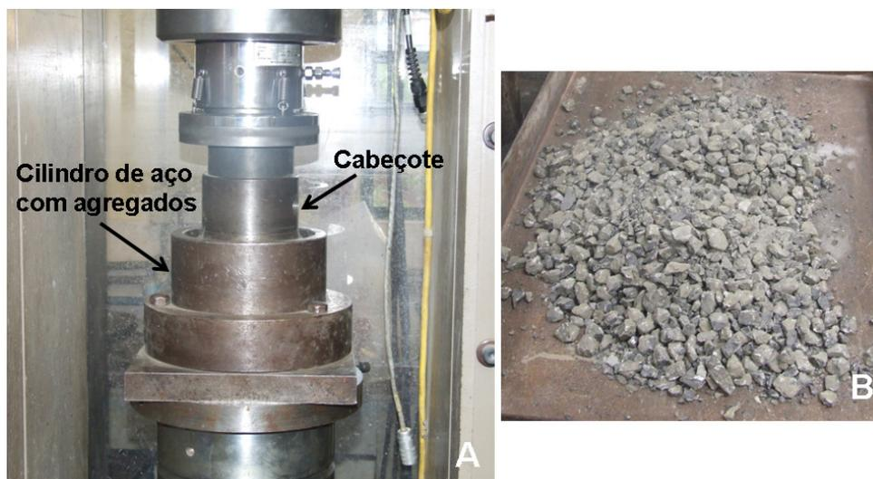
Figura 4.3 - (a) Cilindro de aço com amostra sendo submetido à compressão em prensa servo-controlada; (b) aspecto da amostra após o ensaio de esmagamento. Laboratórios de Mecânica das Rochas do Departamento de Geotecnia da EESC/USP. Detalhes do equipamento encontram-se descritos no item 3.4.3
