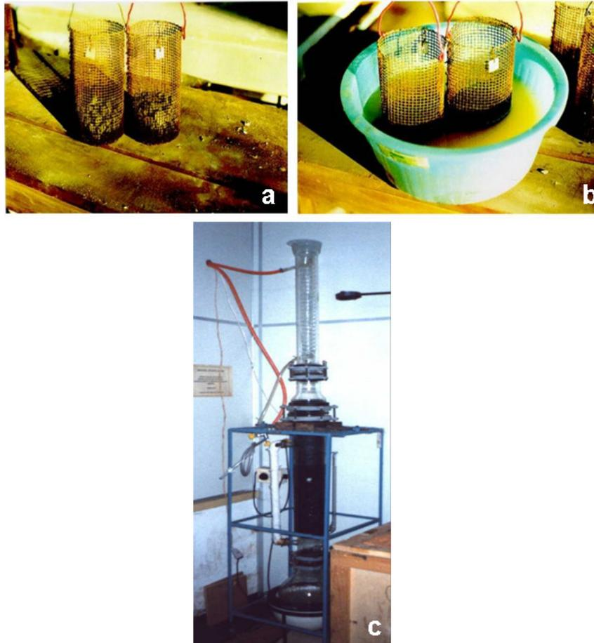
Figura 3.17 - Esquema ilustrativo de ensaios de alteração acelerada: (a) Recipientes telados com as amostras a serem submetidas à saturação em água e (b) Amostras saturadas a serem colocadas em estufa; (c) Extrator “Soxhlet” para ensaios de lixiviação contínua. Laboratório de Geologia de Engenharia do Departamento de Geotecnia da EESC/USP. Fonte: Paraguassú et al. (2014).
