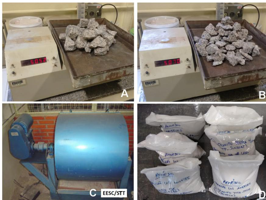
Figura 4.5 - Procedimentos para preparação das amostras (gradação F) para determinação da resistência à Abrasão Los Angeles: (a,b) Pesagem das alíquotas com granulometria 50,8-38,1mm e 38,1-25mm, respectivamente; (c) Equipamento de ensaio e (d) Fração de alguns dos materiais ensaiados passante na #1,9mm. Laboratórios de Geologia de Engenharia do Departamento de Geotecnia e de Estradas do Departamento de Engenharia de Transporte da EESC/USP.
