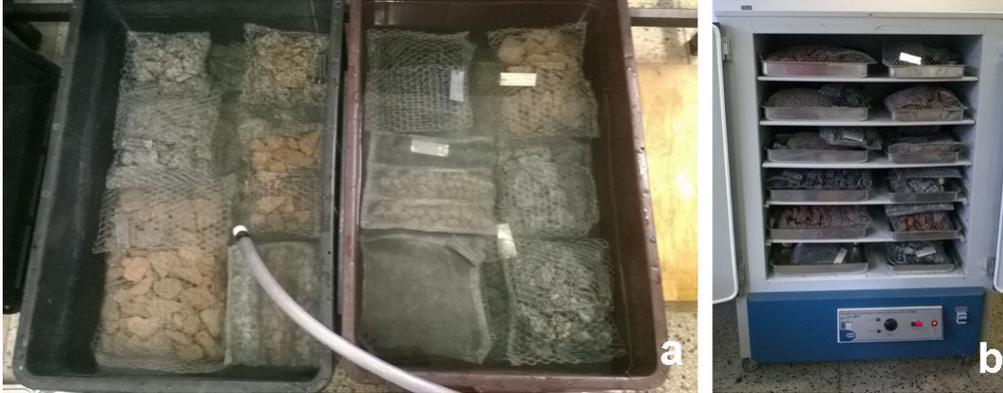
Figura 4.8 - (a) Conjunto das amostras submetidas à imersão em água e (b) secagem em estufa a 100°C. Laboratório da CPRM/Araraquara.
