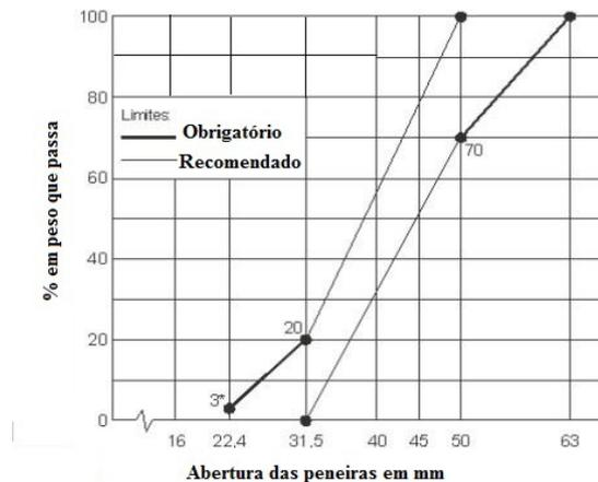
Figura 3.5 - Curva granulométrica ideal para lastros de ferrovia segundo a norma EN 13450 (DIN, 2013). Adaptado de Paderno (2010).
