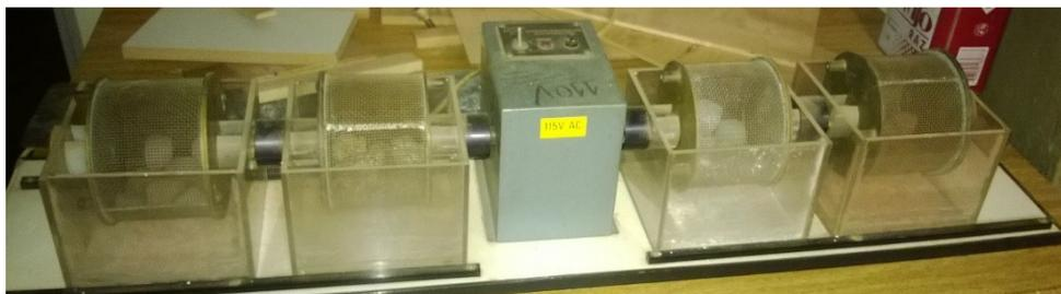
Figura 3.18 - Equipamento existente no Laboratório de Geologia de Engenharia da EESC/USP para realização do ensaio de desgaste a úmido. Foto do autor.
