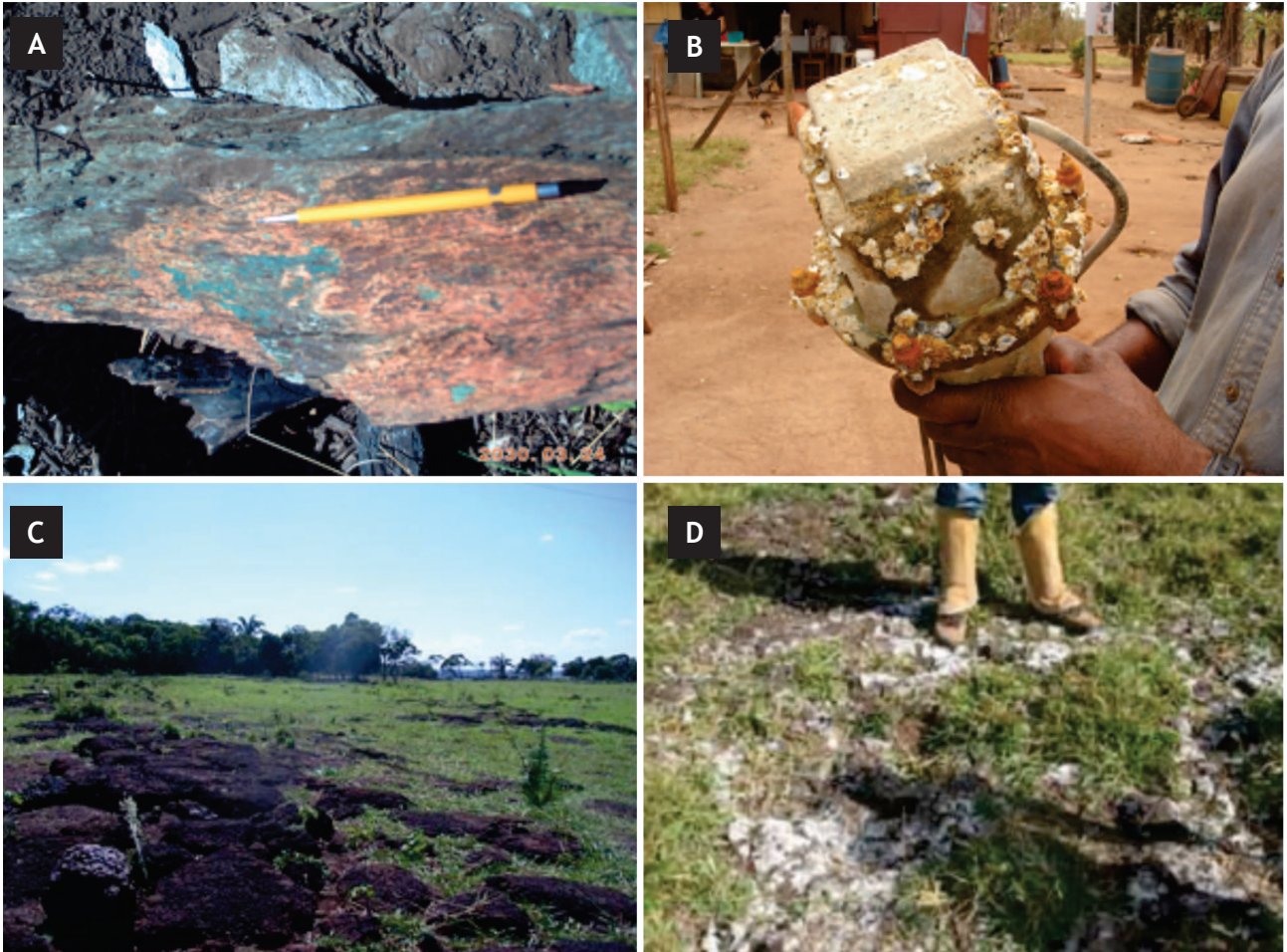
Figura 7.4 – Fotografias dos alvos metalogenéticos a sul da Folha Jauru, parte sul da Faixa Jauru. A) malaquita em xistos do Alvo JTA, B) bomba d'água com incrustação de enxofre (bomba com 4 meses de uso) no Alvo Morro do Coco, C e D) Gossans e sais de enxofre no Alvo J8 (Tabuleta)
