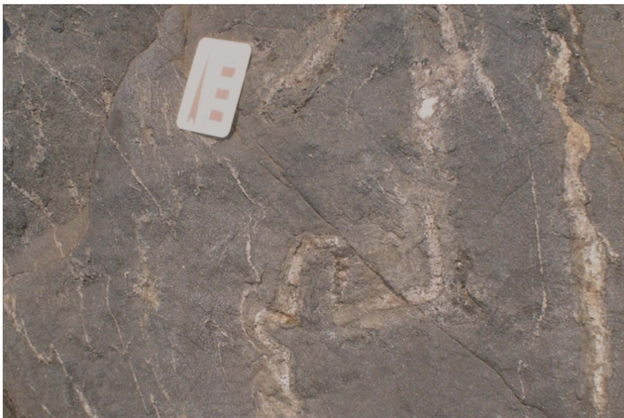
Figura 3.6 – Foto ilustrando aspecto de afloramento de anfibolito bandado, com bandas félsicas, composta por plagioclásio, quartzo e pouco anfíbólio, e bandas máficas composta essencialmente por anfíbólio e plagioclásio. Afloramento situado na Fazenda Quatro Meninas, ponto JA-308 (Coord. UTM 338548, 8303692)
