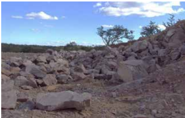
Figura 7.5 – Lavra de granito da Suite Serra da Aldeia para produção de paralelepípedo e brita.
