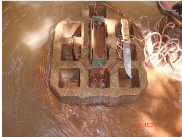
Figura 14 - Data logger de nível de água (Fonte: o autor).
