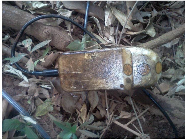
Figura 15- ADCP-Argonaut após as medições em 2103. (Fonte: o autor).
