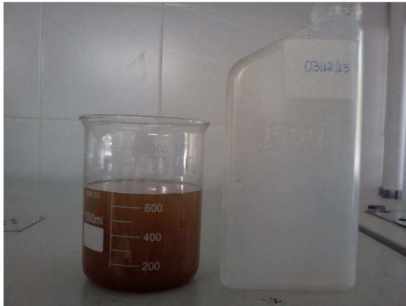
Figura 20- Amostra do dia 03/12/2013 separada em becker de 1000mL necessário a secagem em estufa. Na Figura 21, visualmente a quantidade de sedimento seco é menor que na Figura 22.
