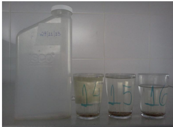
Figura 19- Amostra do dia 29/11/2013 separadas em copos de vidros necessários a secagem em estufa.
