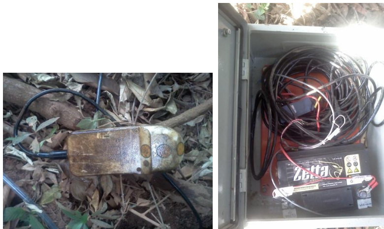
Figura 12 - ADCP Argonaut-SW e instalação adaptada para bateria automotiva. (Fonte: o autor).
