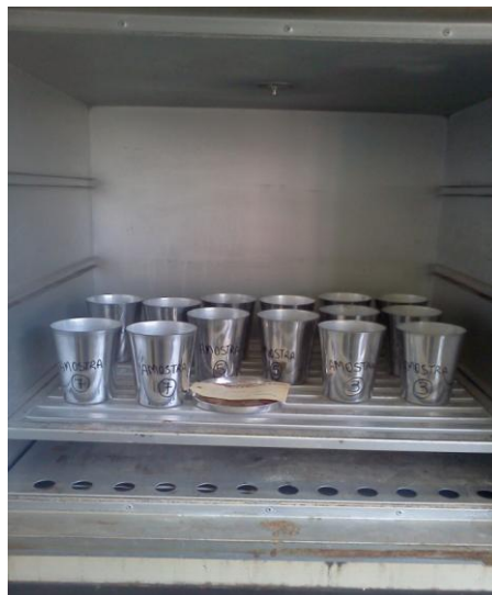
Figura 23- Amostras colocadas em copos metálicos e levadas para secagem na estufa. (Fonte: o autor).
