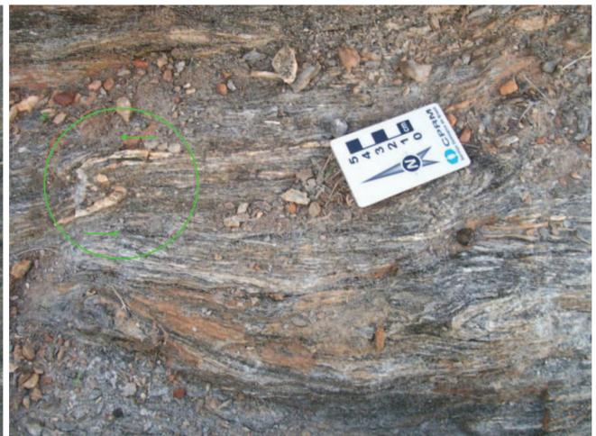
Figura 4.21 – Detalhe do biotita-quartzo xisto em planta, envolvido em zona de cisalhamento provavelmente transcorrente sinistral, sugerida por dobras assimétricas descontínuas e superfícies S/C, destacadas pelo círculo.
