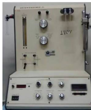
Figura 3.2 – Equipamento de adsorção de \text{N}_2 , modelo Quantsorb Jr., utilizado para determinar a área superficial específica através do Modelo B.E.T.
