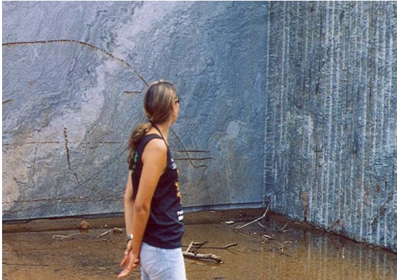
Foto 9.4: Fotografia de parede de pedra do Gnaiss Candeias (folha Oliveira), ponto PA 78, exibindo o bandamento gnáissico dobrado em estilo plissado com vênulas brancas (quartzo-feldspáticas) mais espessas, em dobras desarmônicas em meio a outras cinzentas.
