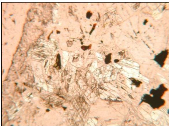
Foto 9.18: Grãos cúmulus de sulfetos com brilho médio a alto (luz refletida, polarizadores descruzados), do tipo pirrotita, ou de possíveis cristais de platinóides ("PGM"?), em meio a fenocristais recristalizados de ortopiroxênio (bronzítico) cúmulus (bronzitito) e a cristais de espinélios metamórficos (pretos). Ressalta-se que os grãos de pirrotita ou platinóides, nessa seção, não permitem uma identificação segura ao microscópio ótico comum (negativo 0221.JPG).
