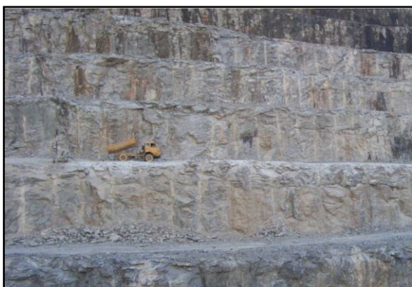
Foto 9.1: Pedreira de Gnaiss Fernão Dias (folha Campo Belo), ponto JC 1262, donde é extraído material para construção civil (cascalhos, britas e saibro).
