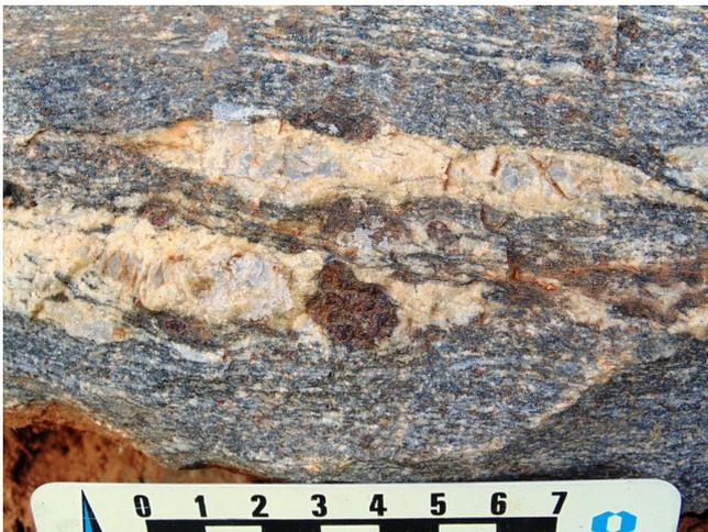
**Figura 3.27** - Granada associada à lente quartzo-feldspática e dispersa na rocha. Ortogneisse do Complexo Cachoeira de Minas, corte na BR-459, a sudeste de Pouso Alegre (0414802; 7538776 UTM).
