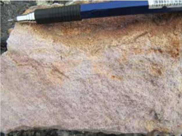
Figura 3.4- Amostra de metarenito micáceo rosado, médio e laminado
