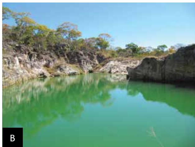
Figura 8.1- B) grande garimpo de quartzo abandonado com vista para a cava inundada
