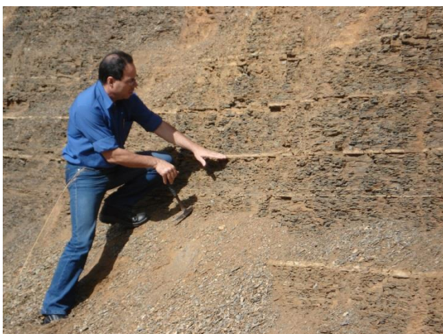
Figura 3.71 - Ritmitos compostos por lâminas contínuas de areia muito fina e silte intercalada por fina lâmina de silte e argila, com pronunciada fissilidade.
