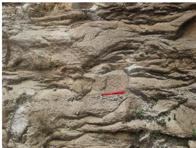
Figura 3.55 - Fm. Furnas. Arenito feldspático, granulometria fina a grossa com grânulos de quartzo subarredondados a arredondados, granocrescência ascendente e geometria tabular.
