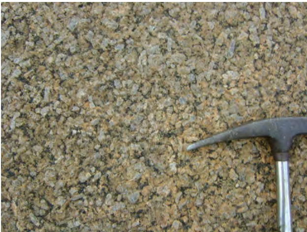
Figura 3.25 – Rocha granítica equigranular associada à suíte São João do Sabugi, nos arredores do Açude Novo (RN) no extremo NW da Folha. Afloramento LU-0412.
