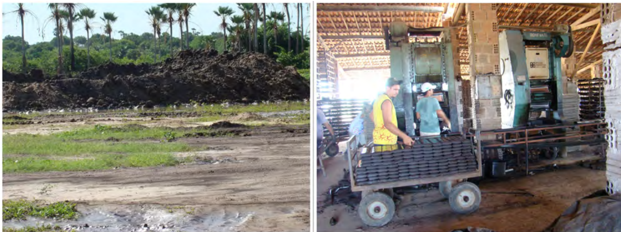
Figura 6.3 – Depósito de argila próximo a cidade de Apodi e o uso desta argila na fabricação de cerâmica vermelha.
