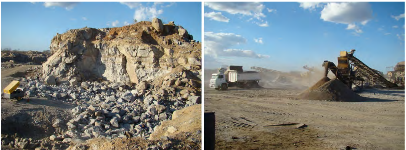
Figura 6.6 – Extração de granito para uso na construção civil (brita) próximo a cidade de Caraúbas.
