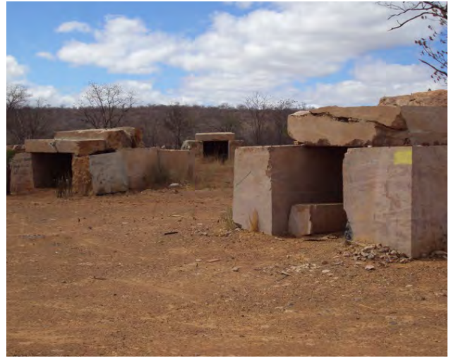
Figura 5.7 – Exploração de gnaiss para a produção de rochas ornamentais em uma pedreira desativada no município de Fronteiras (PI).
