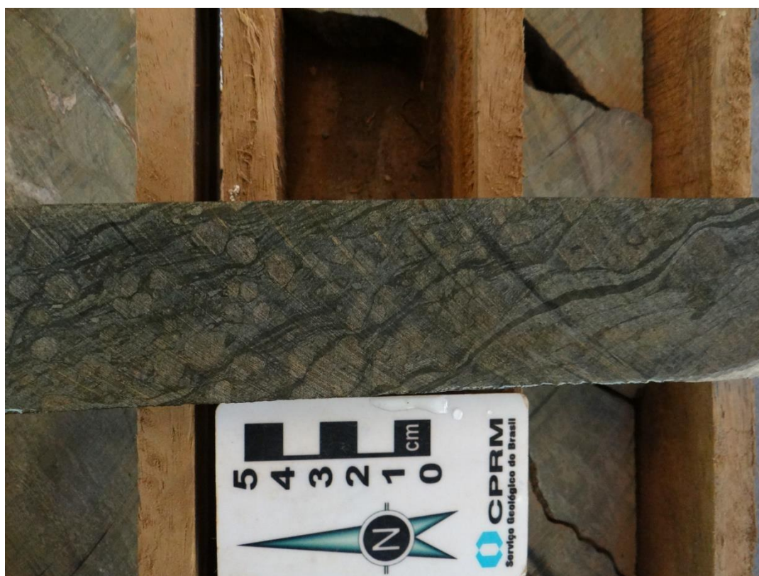
Figura 14: xistosidade fina a média em formação ferrífera bandada de fácies silicato do depósito Salobo. A foliação deflete ao redor dos porfiroblastos de granada. Testemunho de sondagem do depósito Salobo (Furo FD-310, profundidade de 340,03 a 340,10 m)
