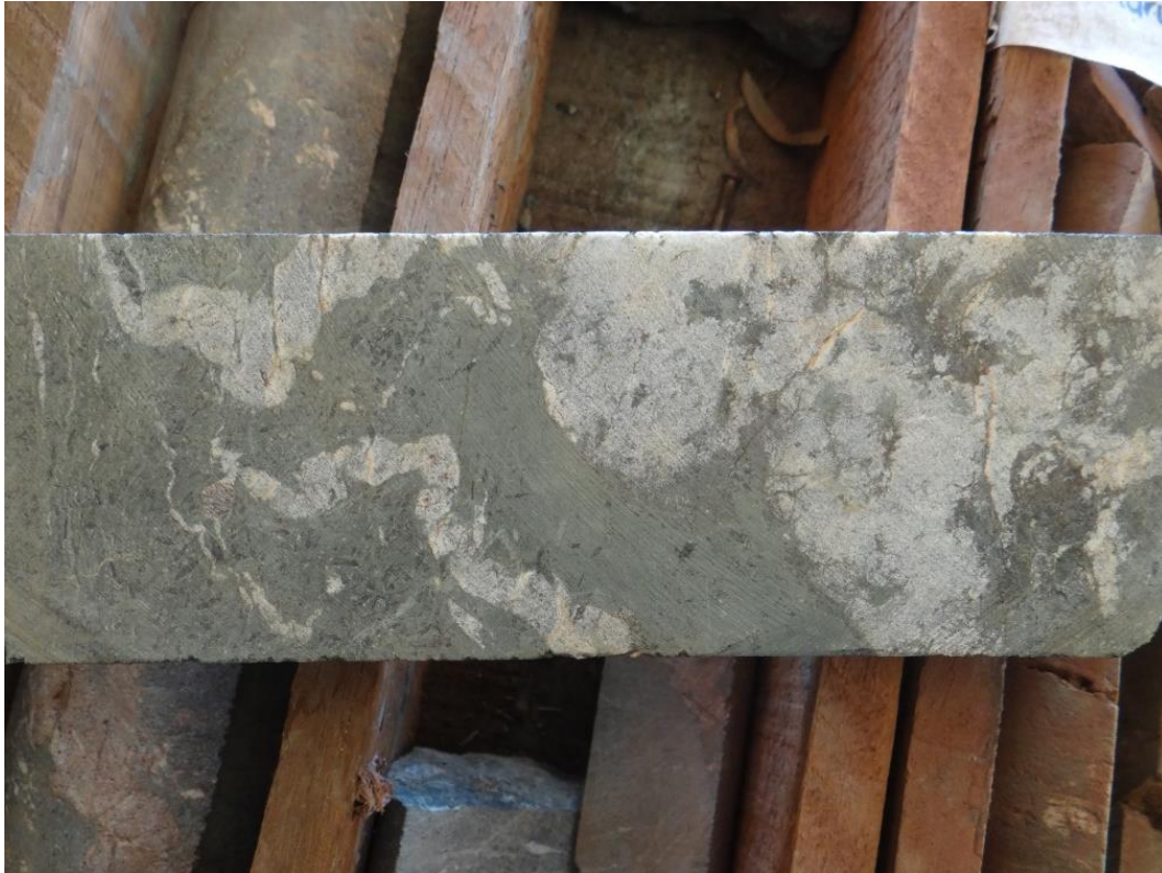
Figura 11: Veio de quartzo e anfíbólio pré-Dn, dobrado, localmente sendo atravessado na charneira pela foliação dúctil principal (Sn). Testemunho de sondagem do depósito Furnas (furo DH-091, profundidade 76,00-76,15 m)
