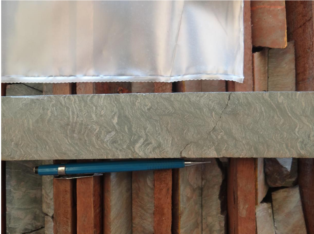
Figura 17: clivagem de crenulação S_{n+1} em formação ferrífera de fácies silicato do depósito Furnas. Testemunho de sondagem (furo DH-091, profundidade de 133,04 a 133,30 m)
