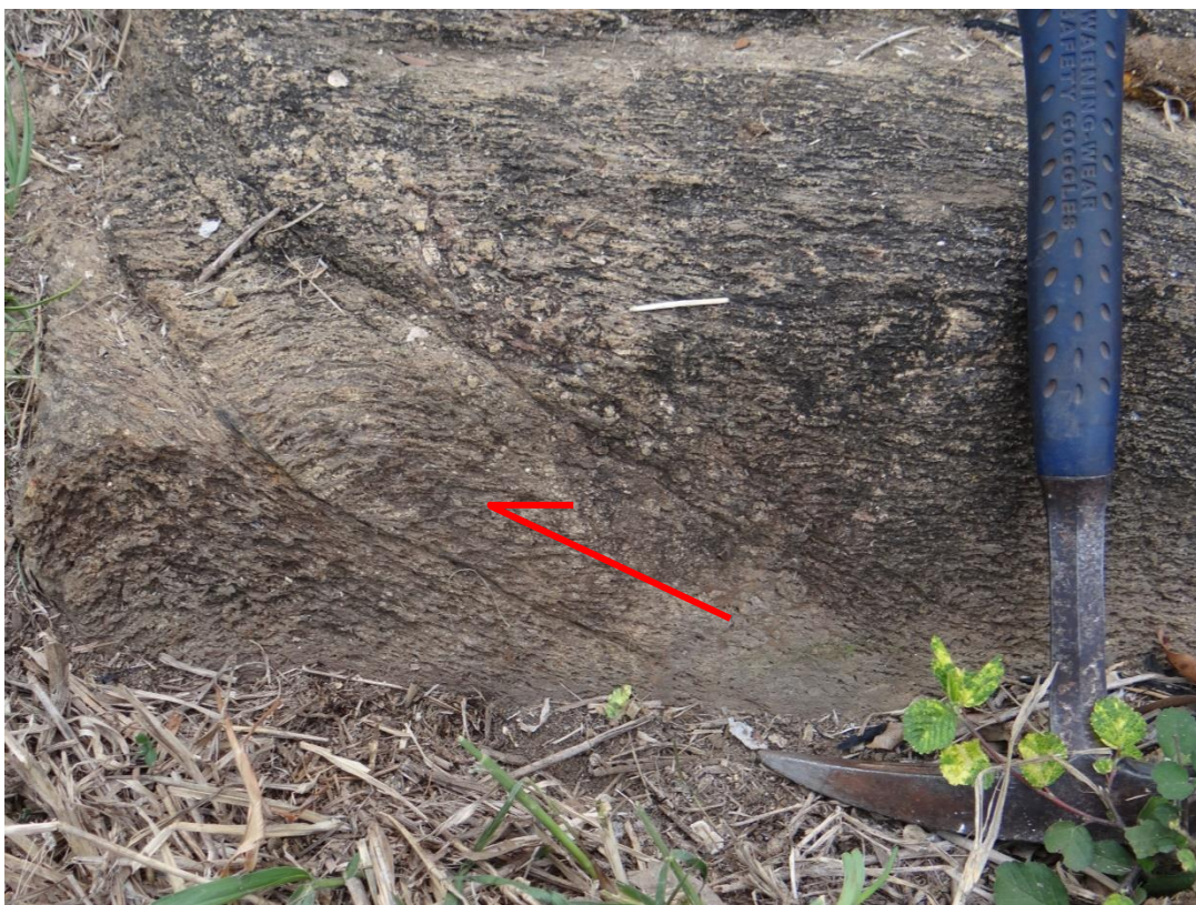
Figura 20: banda de cisalhamento reversa-destal Dn+1, cortando ortognaisse. Nota-se material ultramilonítico escuro ao longo da estrutura. Afloramento próximo ao depósito Furnas.
