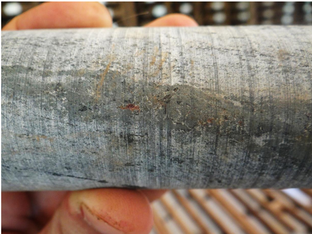
Figura 10: veio de anfibólio (hornblenda), quartzo e sulfeto (bornita), concordante com a foliação dúctil principal (Sn), hospedado em ortognaisse. Observa-se disseminação de anfibólio ao redor do veio. Testemunho de sondagem do depósito Salobo (furo FD-310, profundidade 214,55 a 214,75 m).
