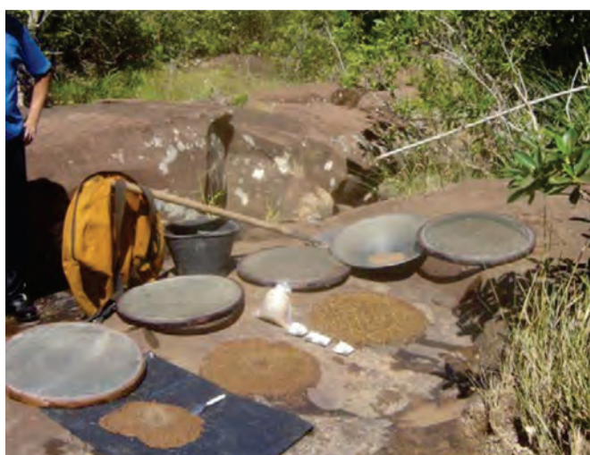
Foto 5.2 – Kit de pesquisa utilizado na amostragem de concentrado de bateia.
