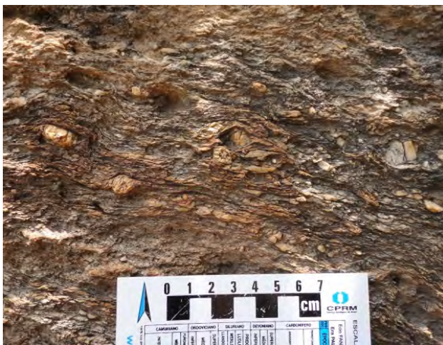
Figura 3.7 – Granada-epidoto gnaiss xistoso mostrando textura porfiroblástica com coloração cinza esbranquiçada, foliada, finamente bandada, rica em feldspato, quartzo, biotita e granada.
