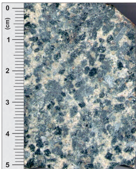
Figura 3.26 – Detalhe de uma seção serrada da rocha gabrítica/diabásio pórfiro da região de Aracá, município de Corrente-PI.
