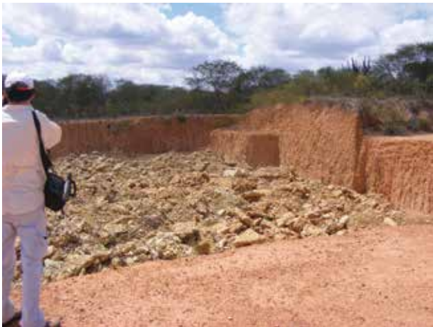
Figura 7.2 - Visão de uma cava de grandes dimensões para retirada da areia do depósito aluvionar antigo, usada na construção civil. Afloramento 538, município Serra do Mel
