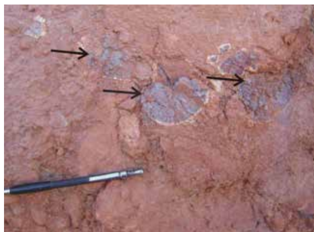
Figura 4.18 - Arenito do Grupo Barreiras com concreções lateríticas. Local: extremo nordeste da Folha Mossoró, afloramento 300, município de Areia Branca
