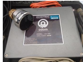
(b) Ecobatímetro ODOM
