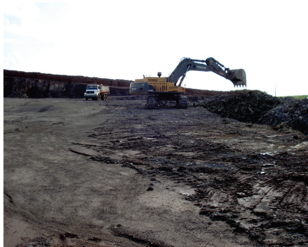
Figura 4.2 – Desmonte mecânico com escavadeira, transporte por meio de caminhões e área de estocagem ao ar livre em mina de argila no PCSG. Fotografia: Roberto Loreti Junior, 2013.
