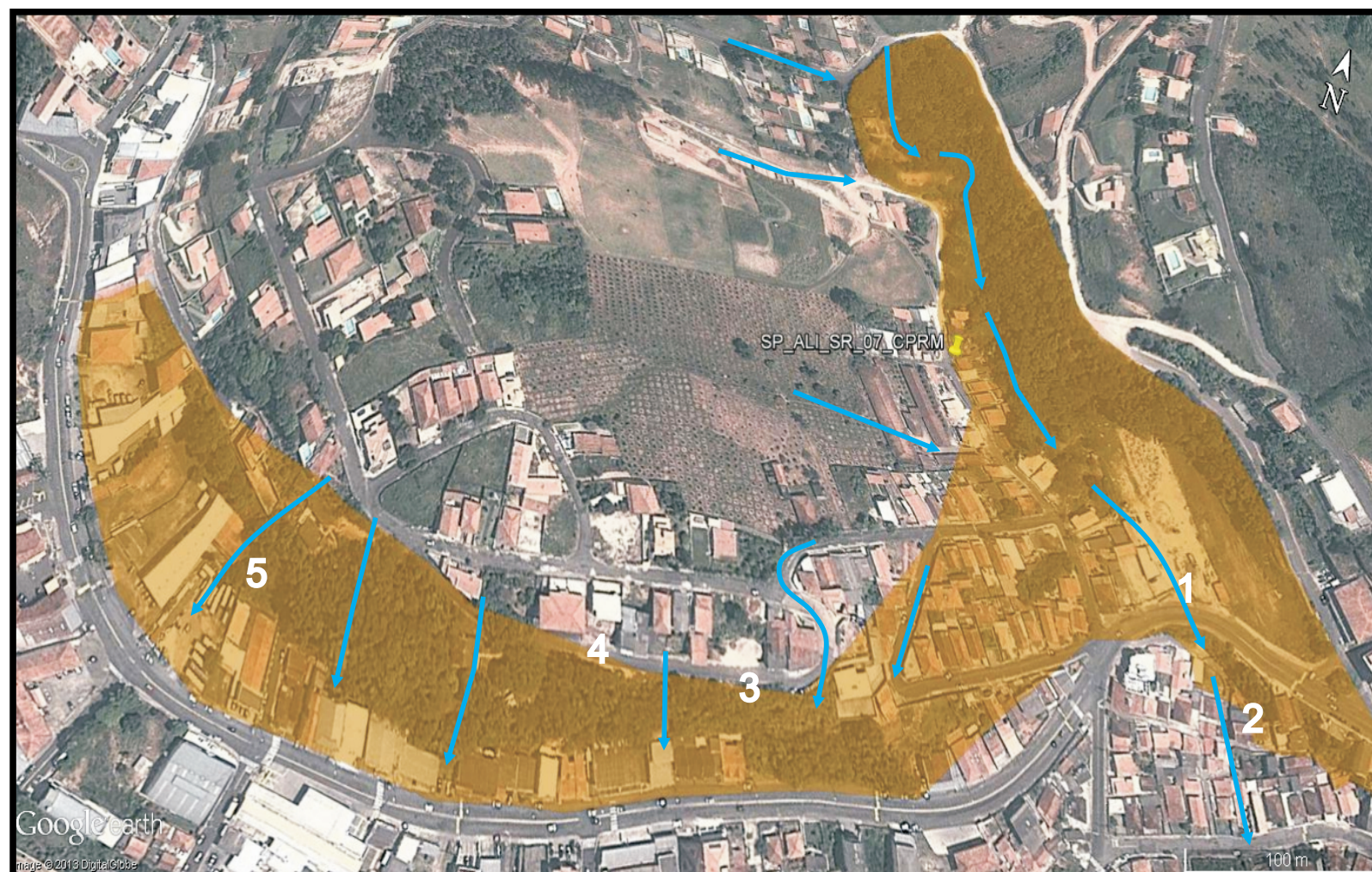
1 Drenagem aterrada que sofreu recalque por erosão
