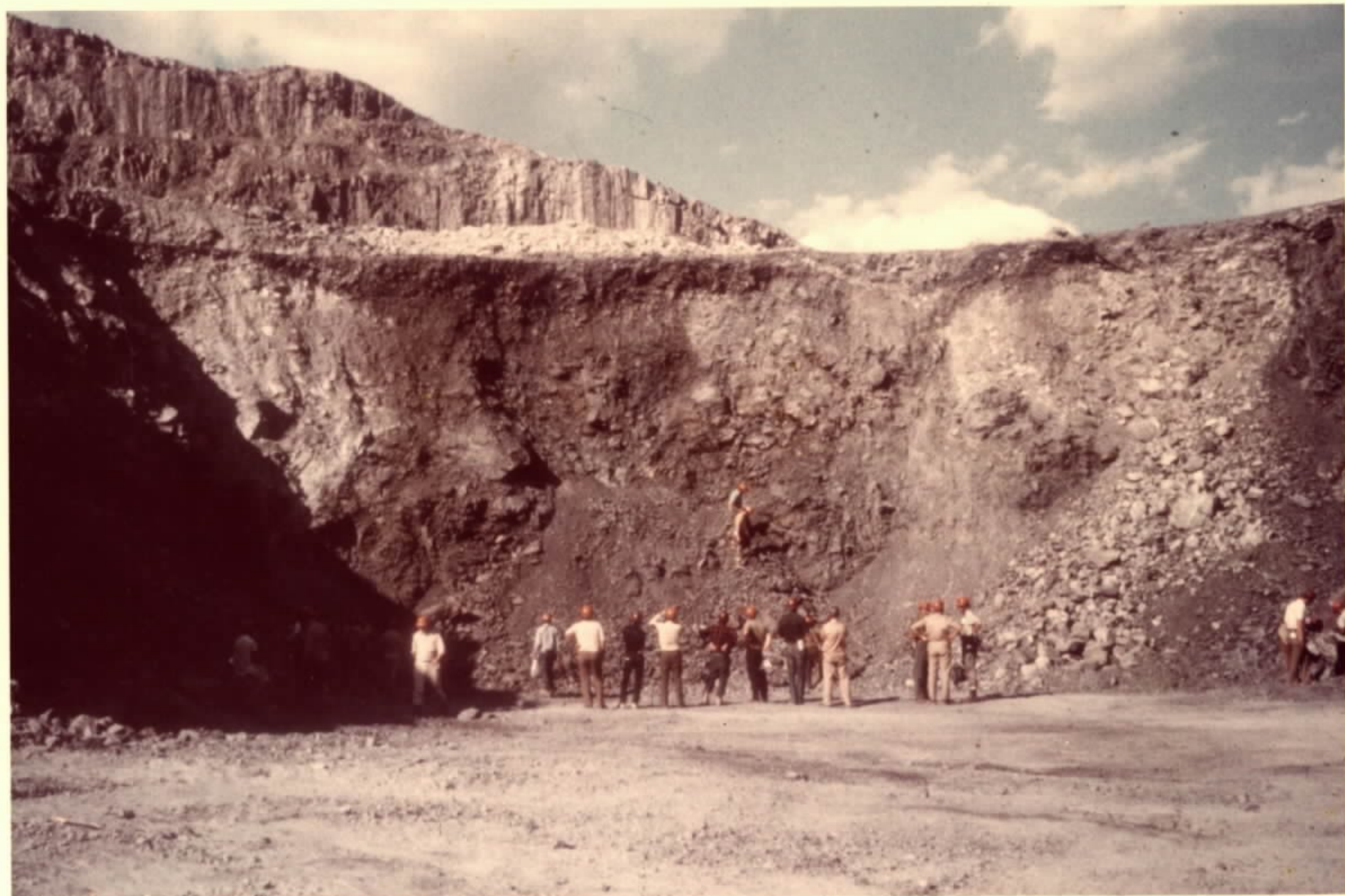
Mina Pipe-2, Thompson, Canadá. Minério maciço de Ni/Cu (10m de espessura) em contato com xistos e quartzitos.
