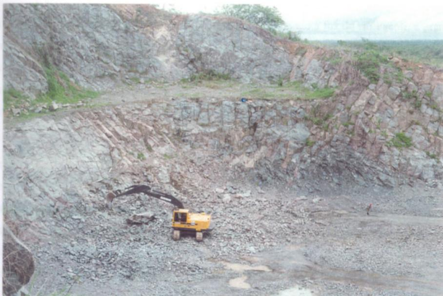
Figura 2.5 - Exposição de pedreira do corpo vulcânico Caruru (fonolito), mostrando representatividade de fraturas. Local: Região da foz do rio Pacoti.
