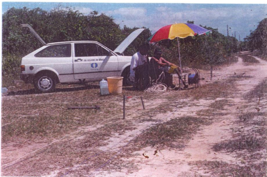
Figura 5.4 – Disposição, em campo, na aplicação do método elétrico de eletrorresistividade, através do arranjo Schlumberger na Região Metropolitana de Fortaleza. Local: Região de Prainha – Aquiraz-CE.
