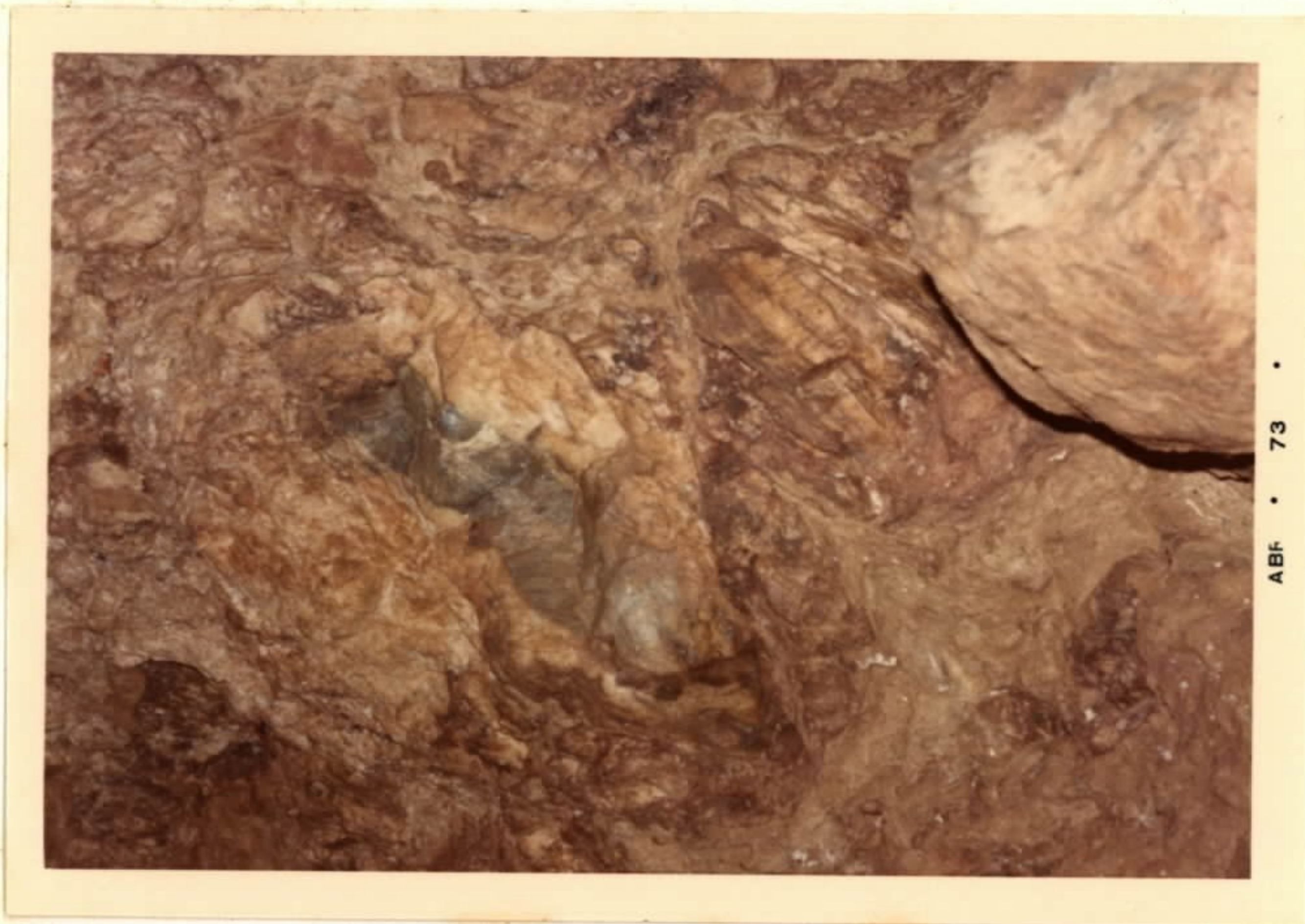
FOTO 13 - "Bolsão" de epidoto-sulfetos em zona muito fraturada do veio de quartzo. Mina do Chapéu do Sol, Crixás, Goiás.
