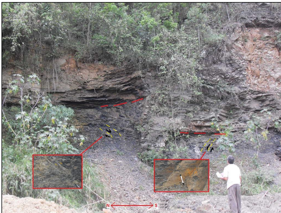
Figura 3.3. Estrutura em flor negativa afetando unidade sedimentar da Bacia do Paraná e associada com a intrusão de um dique de diabásio (canto superior direito da foto).
