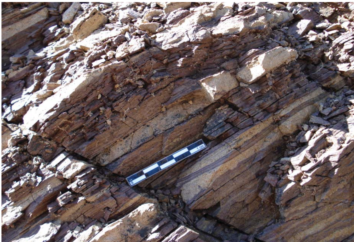
Figura 151 - Ritmito formado por interestratificações de arenito, pelito e argilito de cor castanho achocolatado, inclinados e com tabularidade predominante. Depósito por decantação dos sedimentos em suspensão com marcas de ondas trativas, representando fácies de tempestitos. Formação São Rafael (afloramento CK130). Foto perpendicular ao corte da estrada (tamanho da escala: 5cm).
