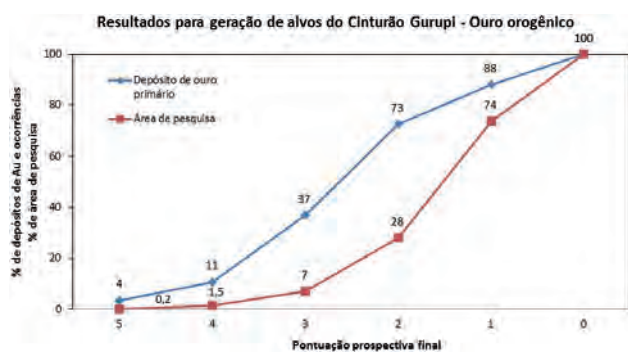
Figura 8.18 – Resultados do mapa prospectivo do Cinturão Gurupi. O gráfico mostra a porcentagem de depósitos e ocorrências de ouro contidos dentro de cada zona de pontuação do mapa de prospectividade (linha azul). Semelhantemente, a porcentagem da área ocupada por cada polígono em relação à área total (linha vermelha). Notar que quase 40% dos depósitos e ocorrências minerais estão contidas dentro de apenas 7% da área, nos escores 5, 4 e 3.
