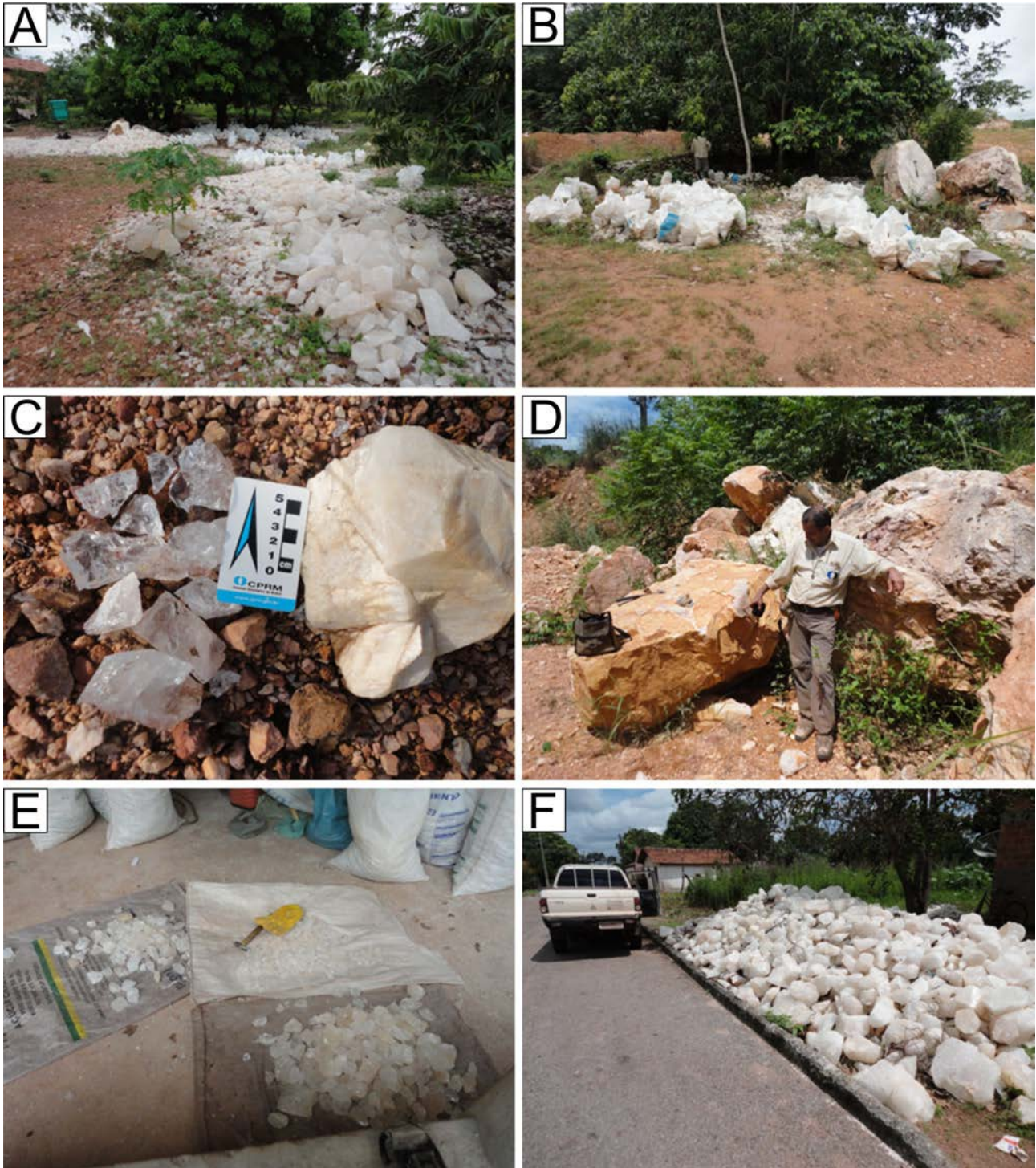
Figura 6.75 – Características do cristal de quartzo da região de Cristalândia – TO: A) Quartzo leitoso com alto grau de pureza, utilizado na limpeza de moinhos. B) Detalhe da fotografia anterior, mostrando o quartzo ensacado, pronto para o transporte. C) Cristal de quartzo leitoso e lascas de quartzo hialino de alta pureza. D) Mega cristal de quartzo. E) Produção artesanal de lascas de quartzo de alta pureza, para exportação. F) Pilha de quartzo leitoso a espera de comprador.
