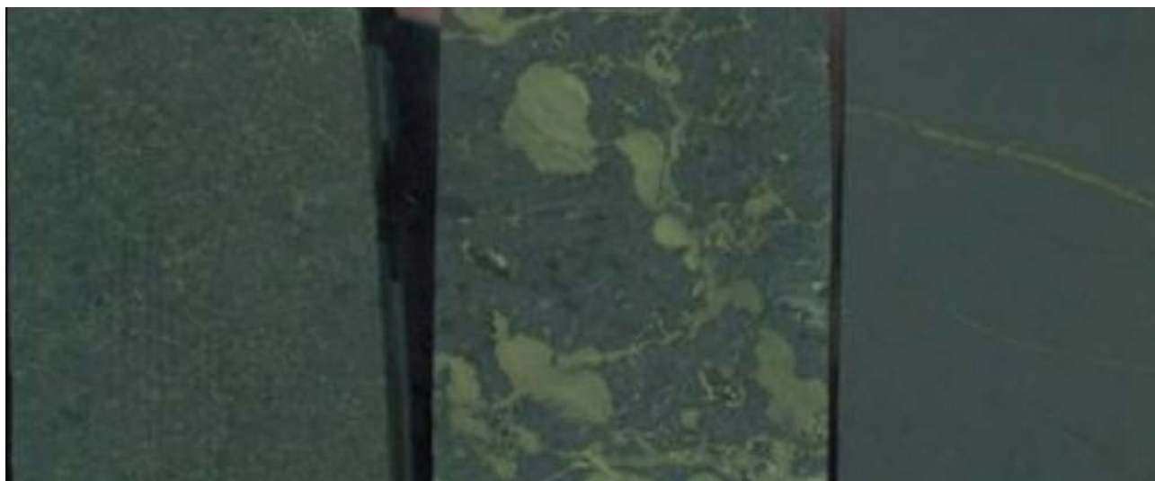
Figura 3.239 – Tabletes de amostras, a partir das quais foram confeccionadas as lâminas delgadas representativas das principais litologias desta subunidade.
