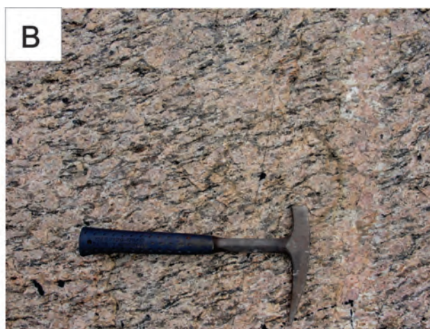
Figura 6.15 – Granito Serra Dourada A) Vista da Serra Dourada; B) Biotita Granito homogêneo de coloração rosa com porções pretas no Granito Serra Dourada, ponto HP-341 (760930/8531335).
