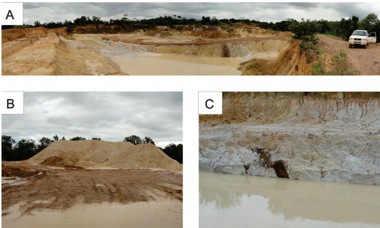
Figura 6.14 – Imagens de garimpo paralisado de argila caulínica no Anortosito Córrego das Campinas HP-167 (727296/8524728). A) Frente de lavra do garimpo; B) Pilhas de argila caulínica; C) Argila caulínica com lentes anfibolíticas intensamente alteradas.
