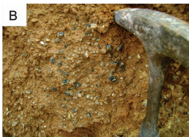
Figura 3.67 – A) Afloramento HP-006 (720997/8562131) com muscovita xisto intensamente alterado, situação muito comum na unidade. B) No mesmo afloramento, destaque para cristais de turmalina e quartzo em contato de xisto com pegmatito.
