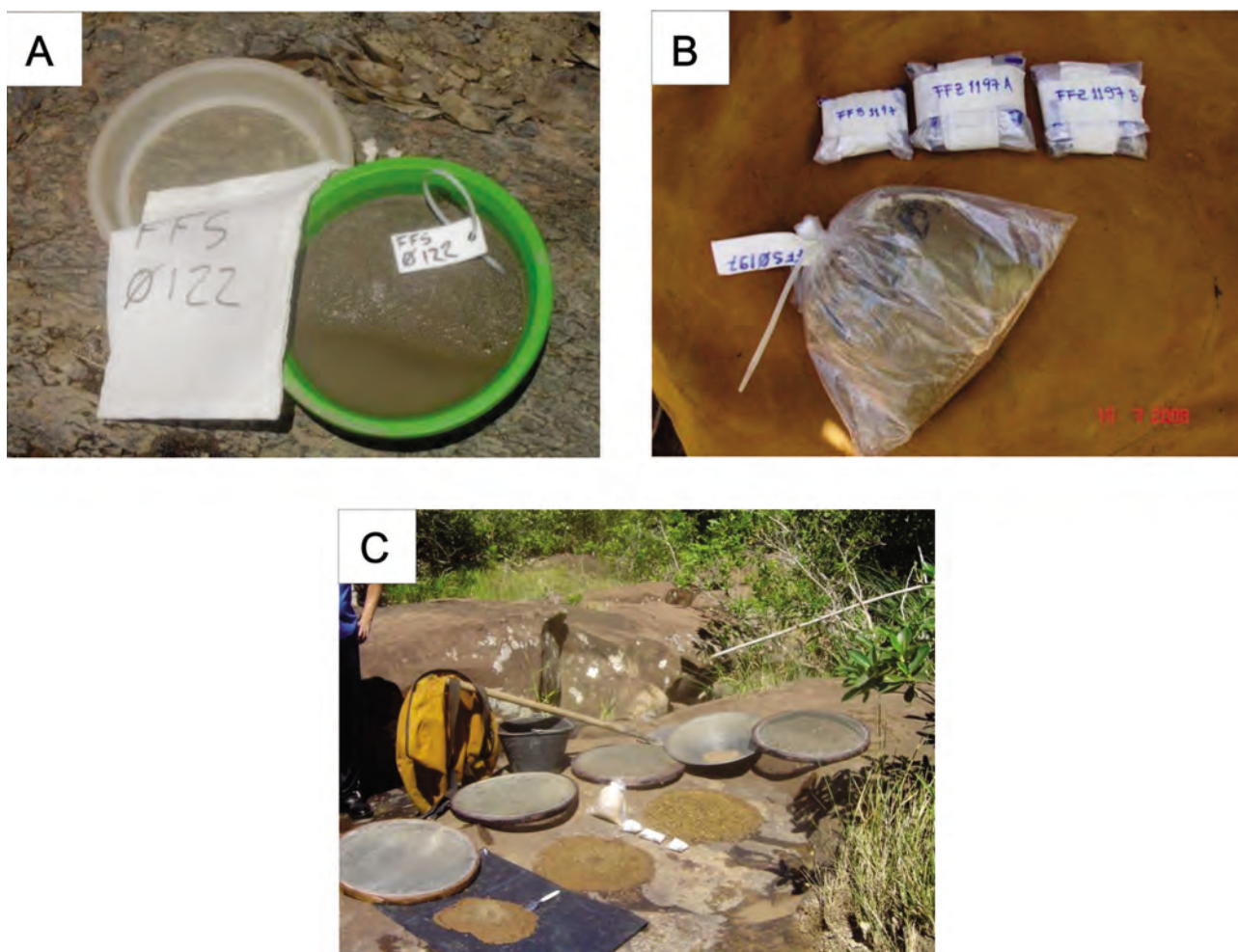
Figura 5.2 – Materiais e métodos utilizados na geoquímica prospectiva. A) Amostra de sedimento de corrente. B) Detalhe da preservação da amostra. C) Detalhes do kit de pesquisa utilizado na amostragem de concentrado de bateia.
