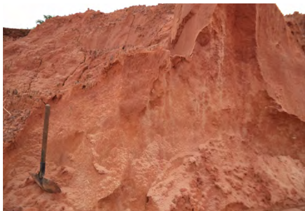
Foto 5.4 - Frente de extração de areia em sedimentos areno-argilosos do Grupo Barreiras (Afloramento KA 005).
