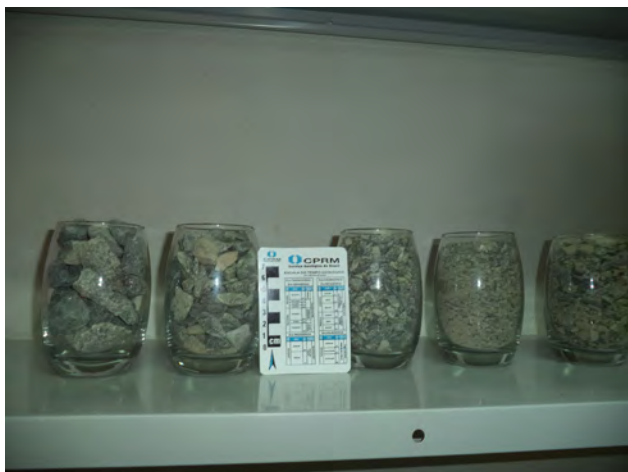
Foto 5.6 – Da esquerda para a direita, amostras de britas 3, 2, 1, 0 e BGS (britas 1 + 0 + pó), conforme denominações utilizadas pelas empresas de mineração na região de Rosário e Bacabeira (MA) – Afloramento LL 025.
