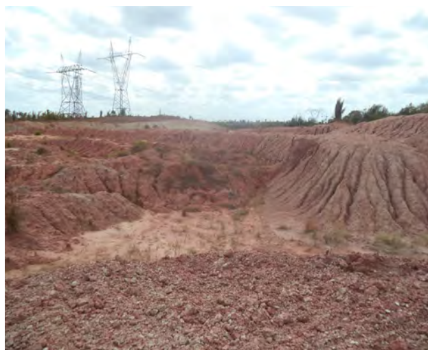
Foto 7.11– Área de mineração de argila abandonada, mostrando incidência dos processos de erosão pluvial e sem qualquer trabalho de recuperação ambiental. Município de Bacabeira (Afloramento LL 066).
