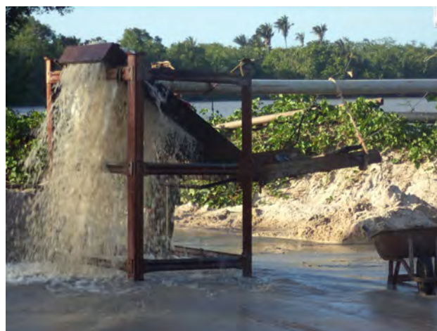
Foto 6.11 – Sistema de grelha fixa separando as frações mais grossas e as impurezas (Afloramento LL 062).
