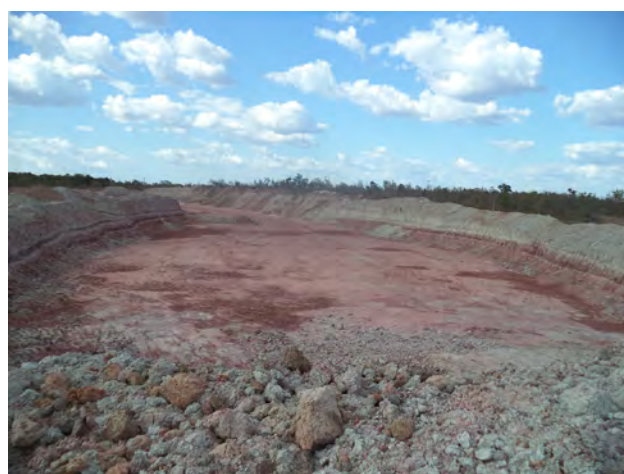
Foto 3.5 – Afloramento LL 094 - Argila cinza, relativamente esbranquiçada, pouco arenosa (areia muito fina), intercalando-se com níveis de argilas avermelhadas.
