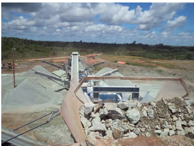
Foto 6.6 – Conjunto apresentado na foto anterior, com detalhe do alimentador vibratório (Afloramento LL 022).
