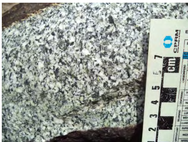
Foto 3.1 - Afloramento LL 049 - Granitoide fanerítico, inequigranular, leucocrático, granulação média, pertencente à Suíte Intrusiva Rosário. O granitoide apresenta uma composição tonalítica. Localmente, observam-se veios de quartzo. A rocha apresenta-se pouco fraturada.
