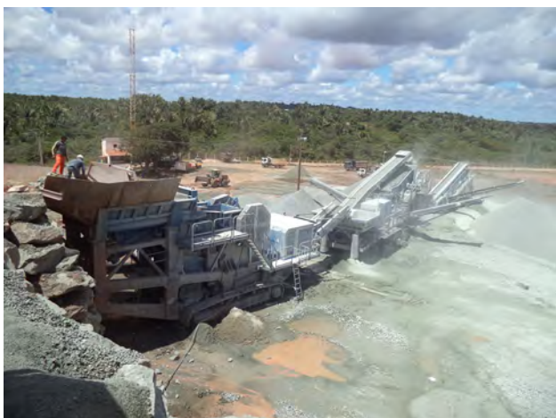
Foto 6.5 – Alimentador vibratório, britador primário, peneiras e correias transportadoras (Afloramento LL 022).
