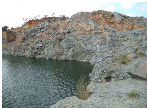
Foto 7.1 – Frente de lavra a céu aberto para produção de brita, onde se verifica a interceptação do nível freático. Município de Rosário (Afloramento LL 026).
