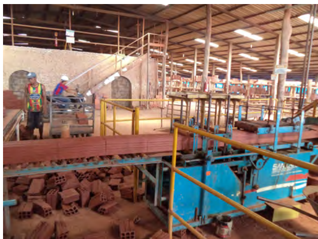
Foto 6.14 – Vista da “maromba” confeccionando tijolos de 6 furos (Afloramento LL 088).
