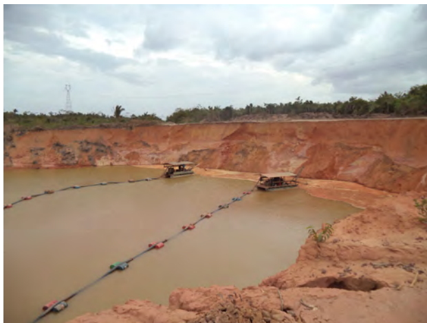
Foto 6.9 – Sistema de barça fixa sustentada por tambores flutuantes (Afloramento LL 079).
