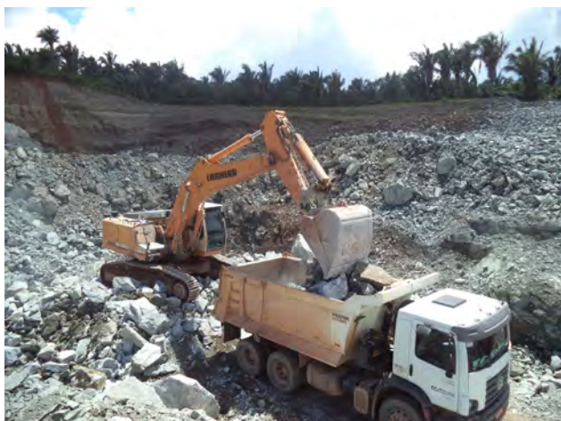
Foto 7.2 – Mostra a espessura do capeamento de solo a ser retirado e o impacto ambiental gerado, mais precisamente no que concerne ao aspecto visual. Município de Bacabeira (Afloramento LL 022).
