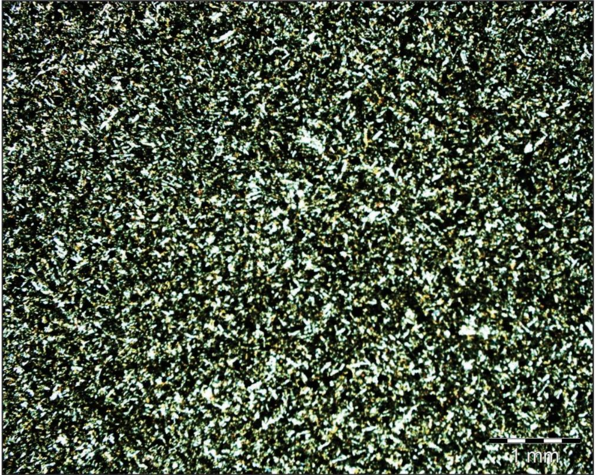
Figura 46: Fotomicrografia de andesito-basáltico coletado no ponto SJ-74 (mB); textura holocristalina intergranular, com plagioclásio e piroxênio modal em porcentagens equivalentes. Luz polarizada.
