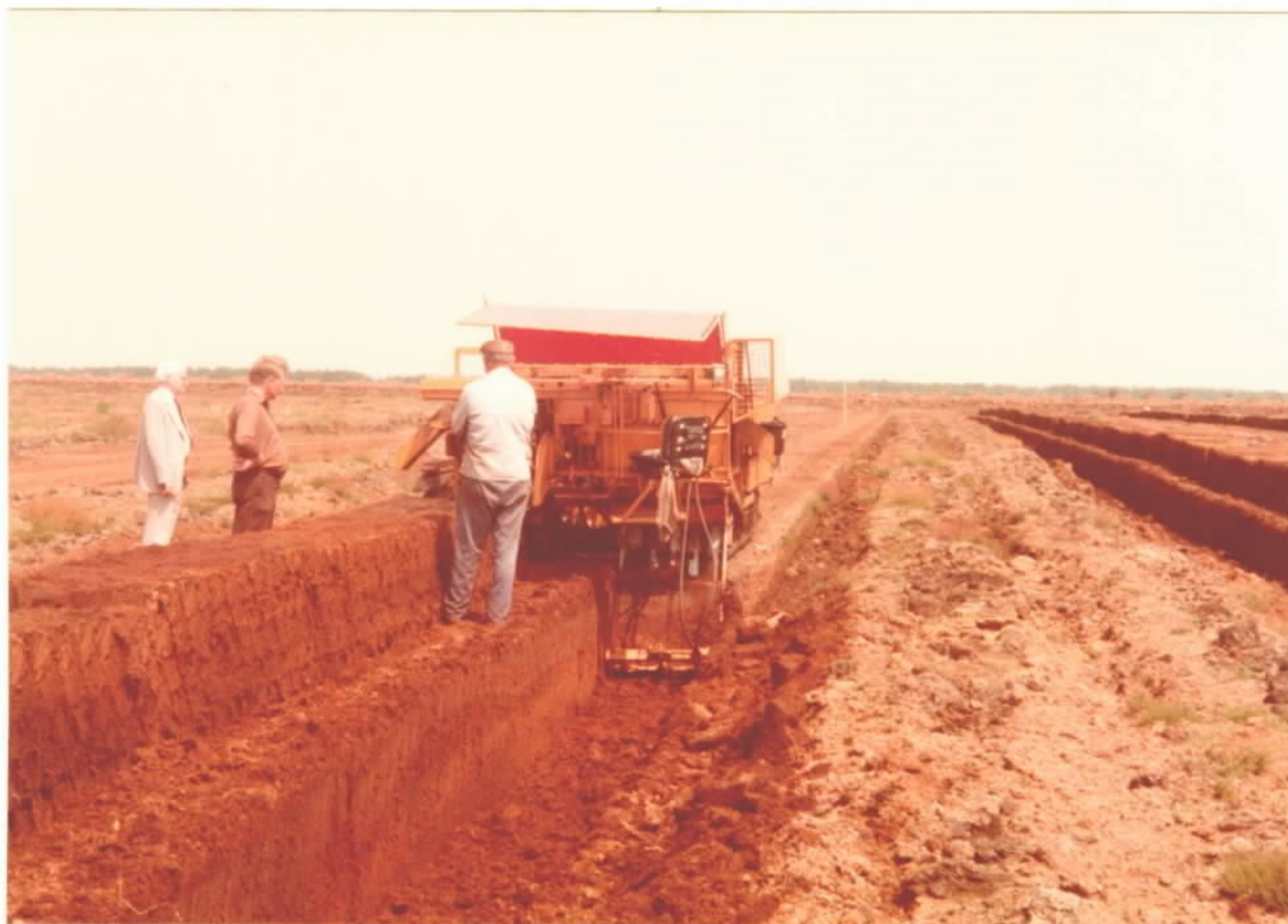
Foto 6 - Corte e empilhamento dos blocos de turfa da camada superior ("white peat").
