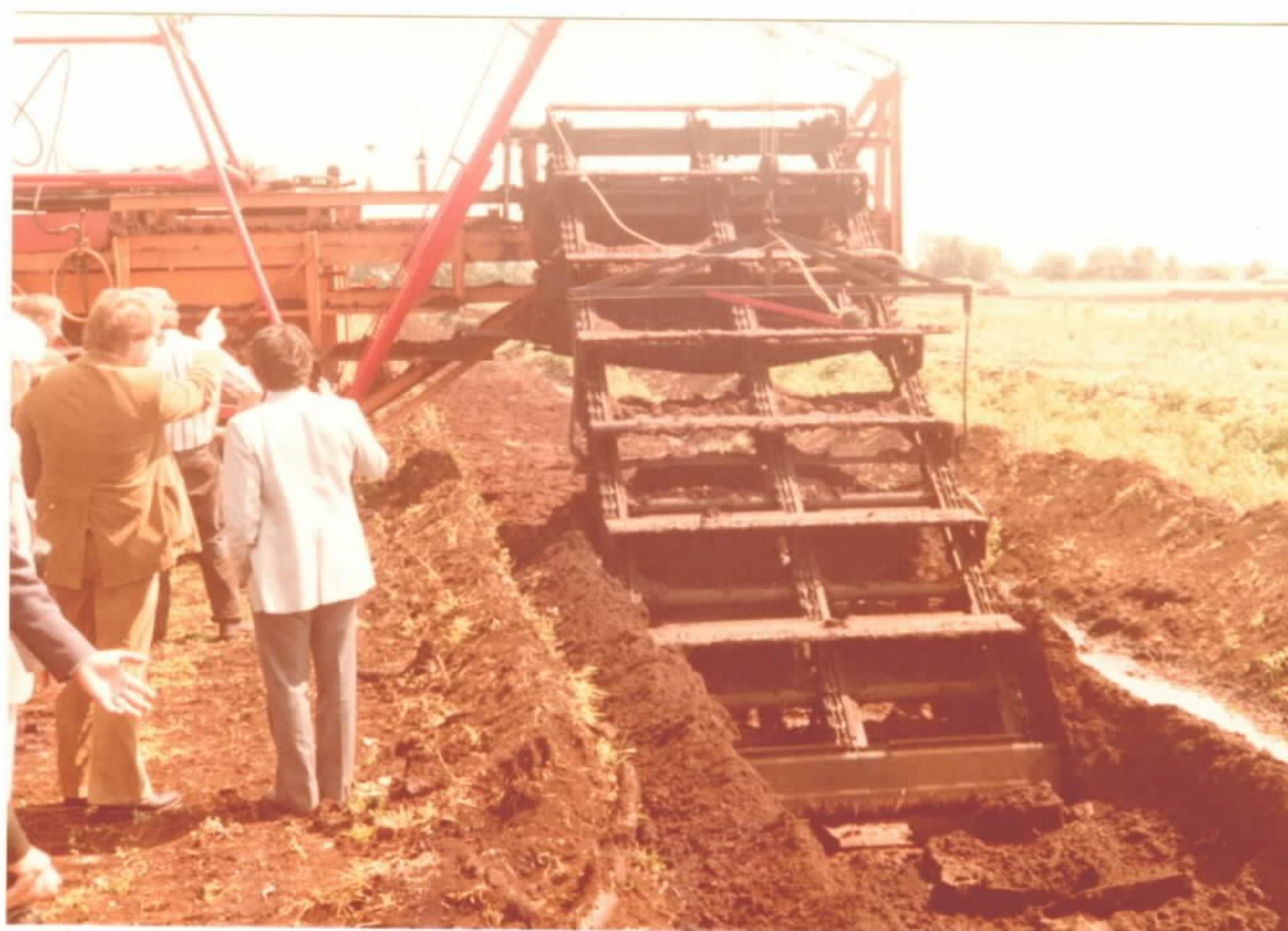
Foto 7 - Extração da turfa da camada inferior ("brown peat")
