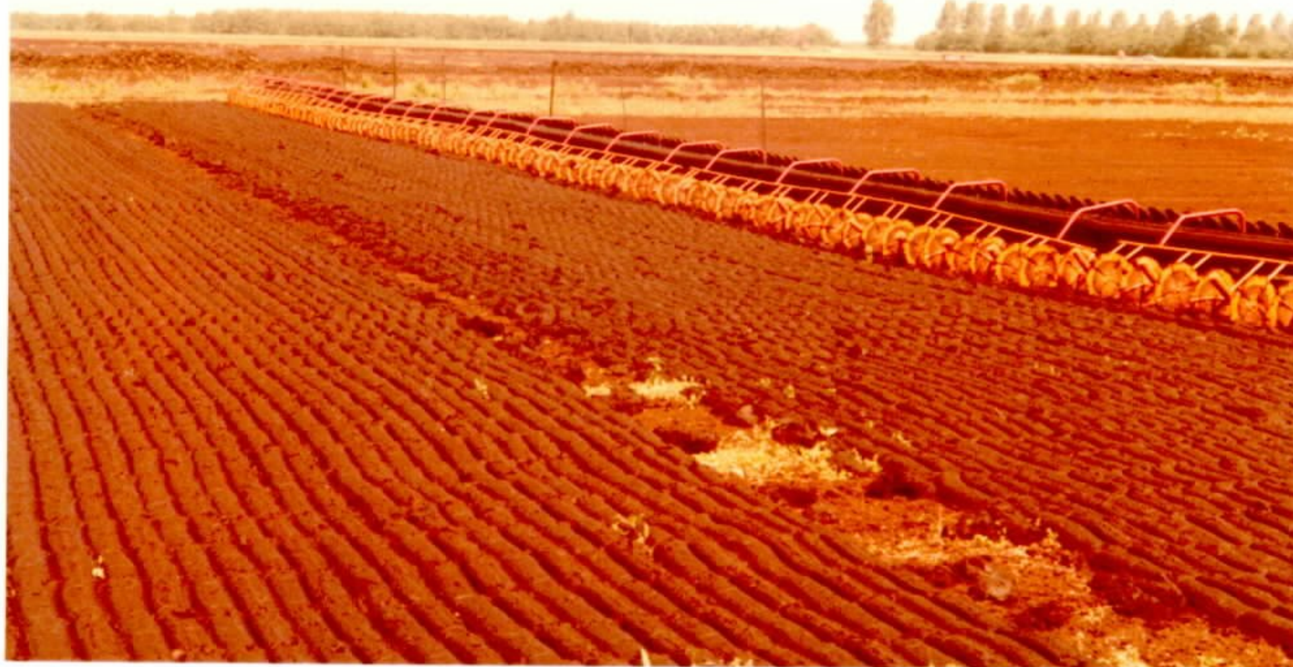
Foto 8 - Secagem de turfa da camada inferior ("brown peat")
