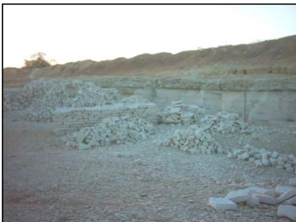
**Foto 24:** Cava de uma mina de calcário de onde se extraem blocos para meio-fio e paralelepípedos para calçamento de rua. Tamanho da cava: 400m x 100m x 3m.
