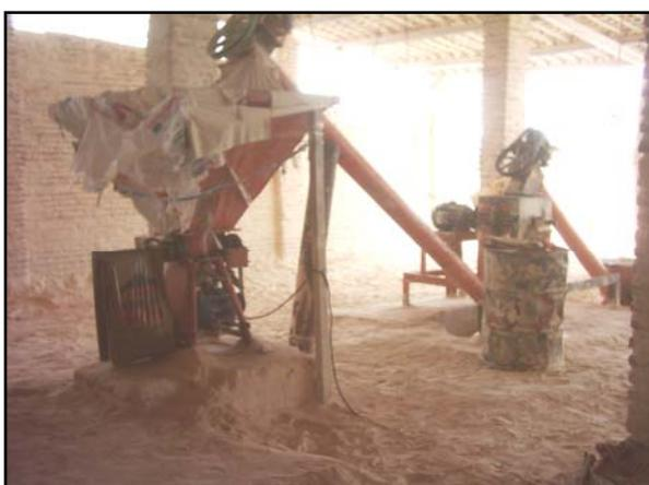
**Foto 26:** Detalhe das máquinas utilizadas na Mineração Cariri para produzir calcário fino para argamassa do tipo "CRECAL". Aproximadamente a 2 km a Sudeste de Pendências.
