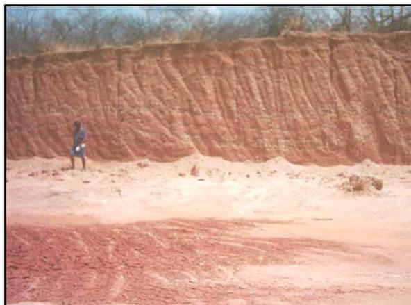
**Foto 19:** Cava de mina paralizada de onde foi extraído grande volume de cascalho do Depósito Aluvionar Antigo (DAA). Dimensões da cava: 350m x 80m x 9m de altura. Aproximadamente a 2 km a nordeste da localidade de Carão.
