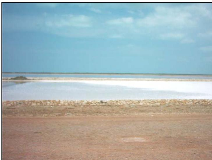
**Foto 28:** Tanque de cristalização final do sal. A porção de cor branca no interior do tanque é o sal sólido pronto para ser colhido com trator. Localidade de Uburana.
