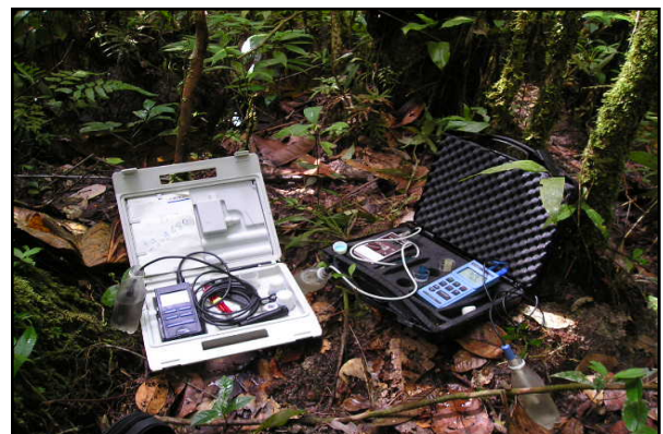
Figura 13 – Aparelhos para medição de pH, oxigênio dissolvido e condutividade elétrica dos corpos d'água amostrados
