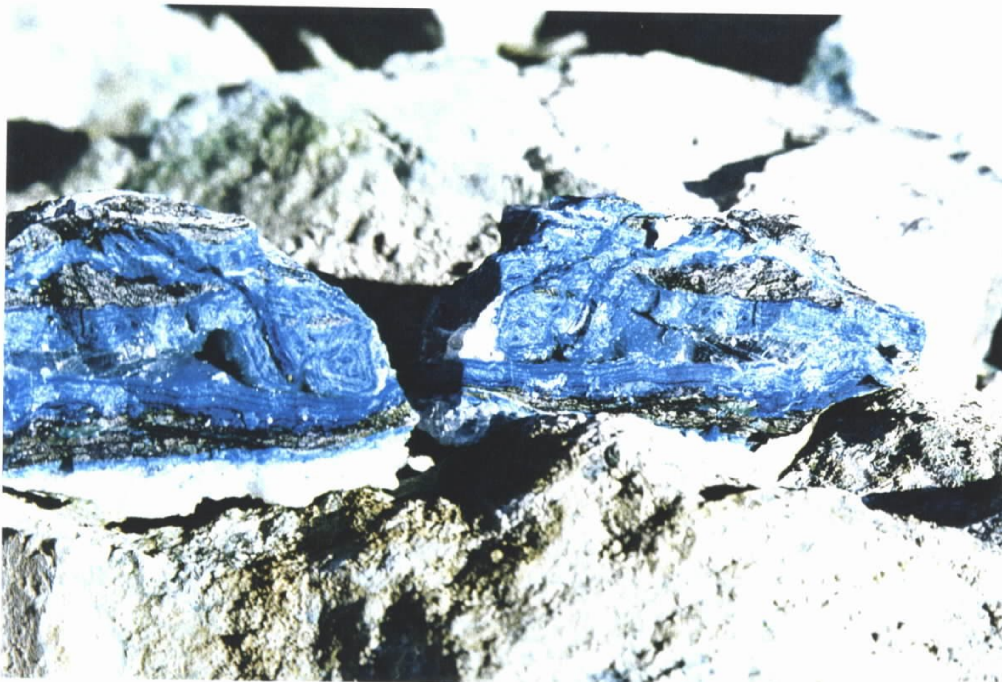
Foto 7 – Mina Sur, constituída por minério “exótico”, de coloração azulada, denominado crisocola, com minerais de gipsita de coloração clara.
