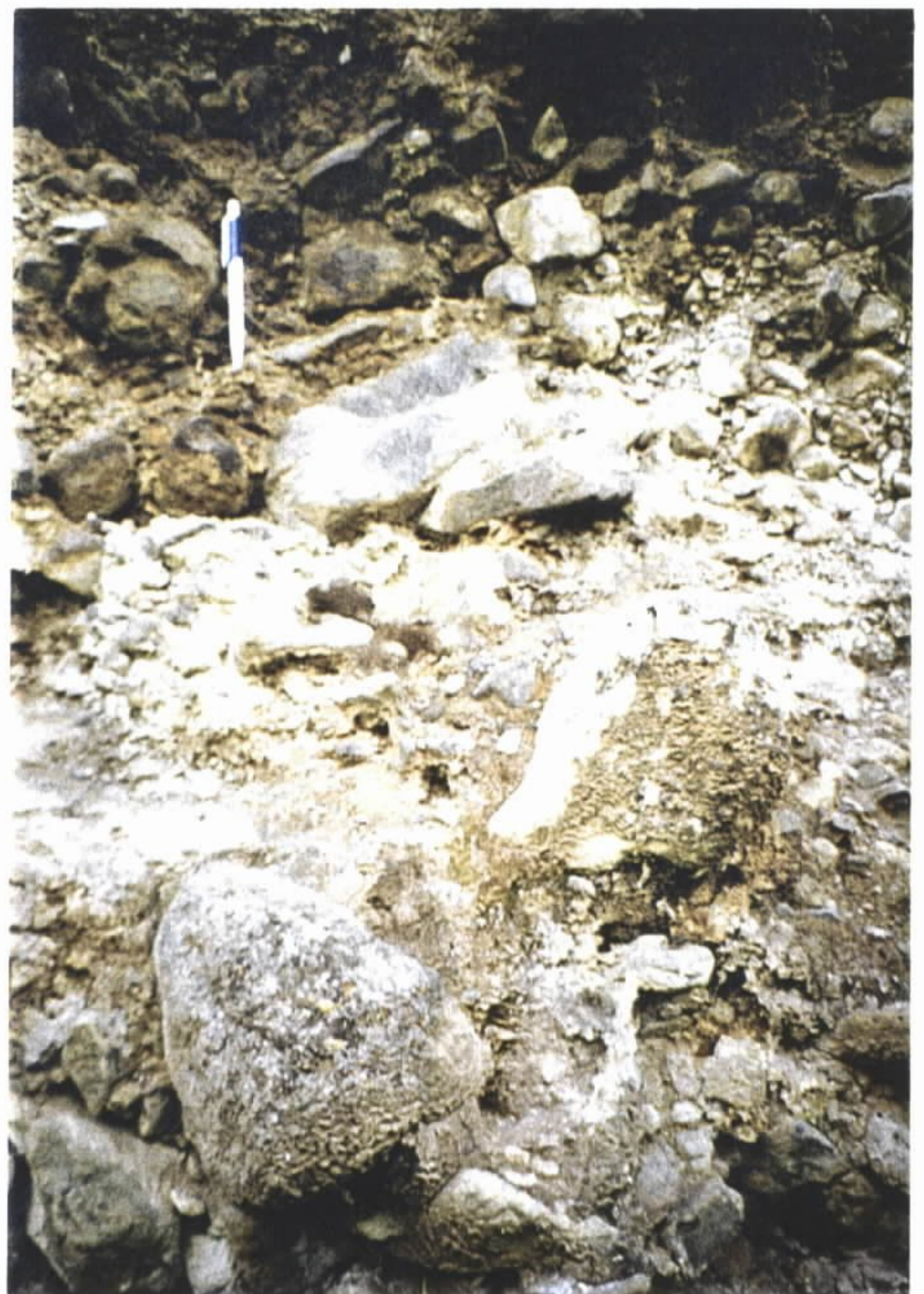
Foto 2 – Detalhe da foto anterior, onde se têm fragmentos angulosos e seixos subarredondados, mal-seleccionados de rochas de idade mesozóica (granodiorito) e terciária (ignimbrito, andesito).
