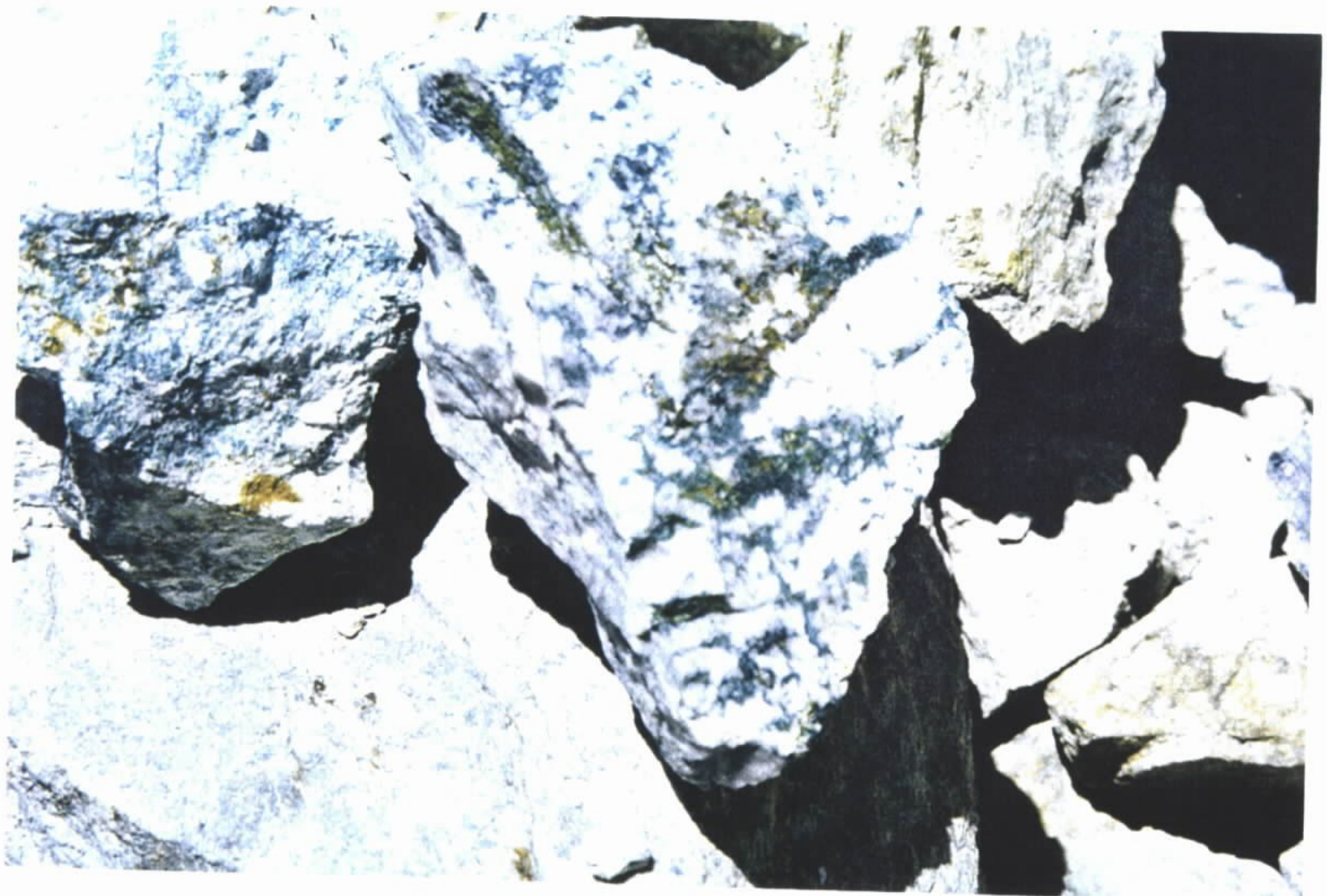
Foto 6 – Minério da mina de Chuquibambilla, constituído, em ordem de importância, por calcita, covelita, calcopirita e bornita, encaixados em rochas graníticas hidrotermalizadas.
