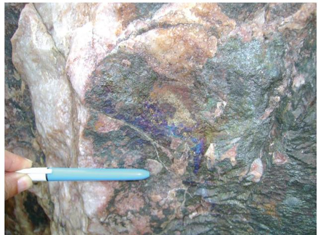
Foto 5.12 - Detalhe da ocorrência de sulfetos de cobre em veio de quartzo (Jucurutu/RN). Afloramento ML-148.
