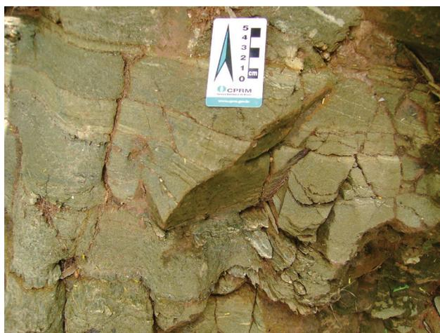
Foto 3.30 - Aspecto de campo dos gnaisses aluminosos, evidenciando uma foliação bem marcante denotada principalmente por palhetas de clorita/biotita (4,5 km a SW de Saco Grande, em Jucurutu/RN). Afloramento ML-178.
