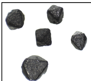
Figura 59 - Amostra de Cromita no microscópio Leica, 20x
