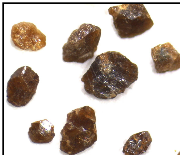
Figura 63 - Amostra EM-B-231, Titanita no microscópio Leica, 20x.
