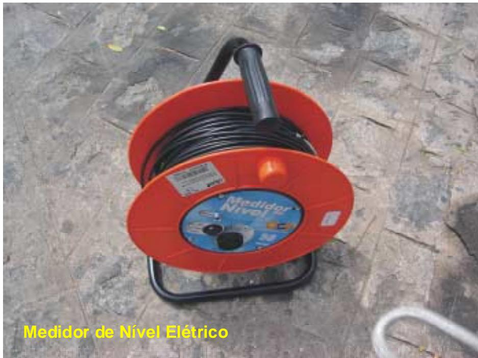
Medidor de Nível Elétrico
