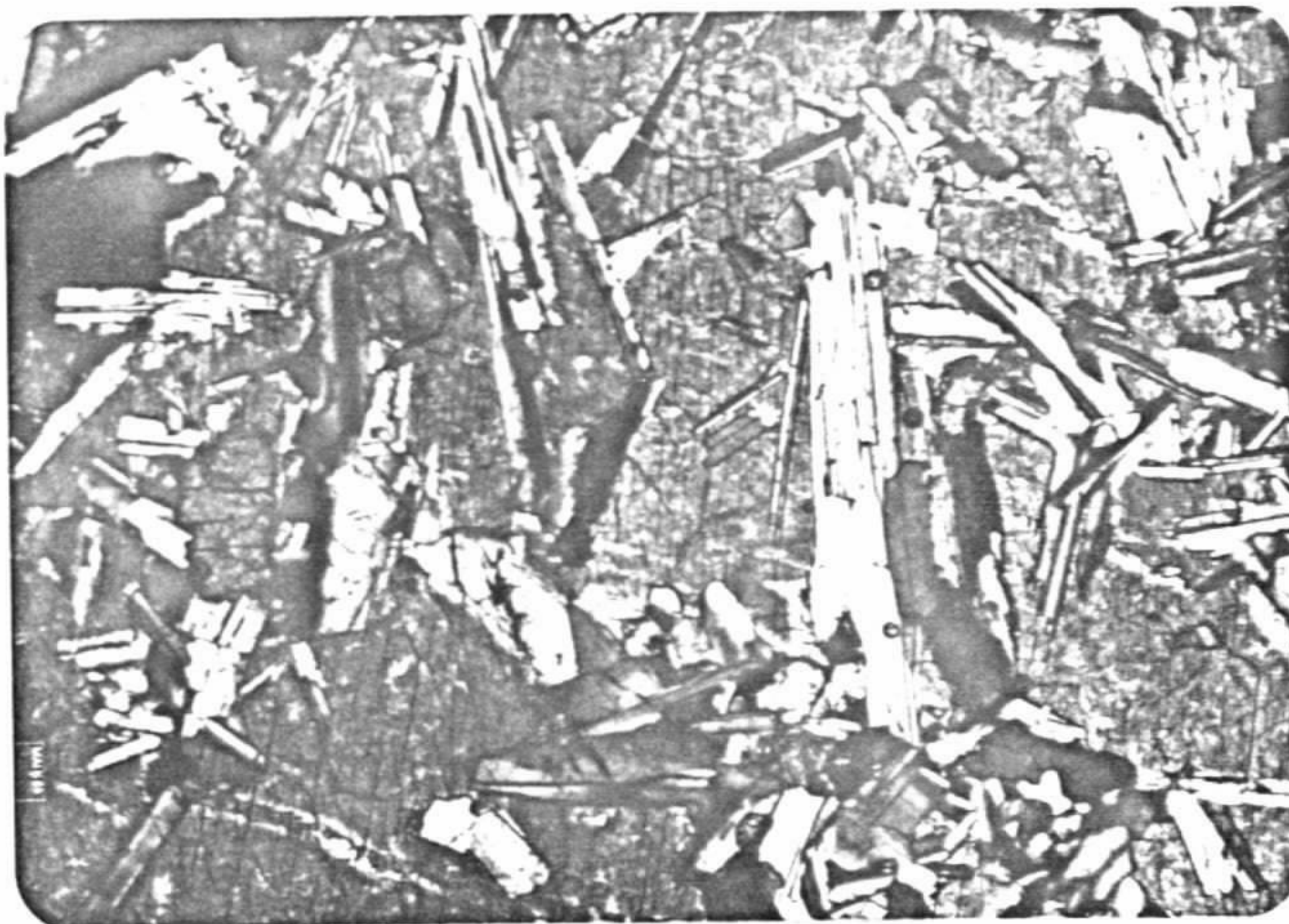
FOTO 18 : Amostra AB-9 - Olivina-diabásio Penetecaua mostrando augita e labradorita em arranjo textural subofítico, tipomorfo, com grânulos olivinícos subordinados.
