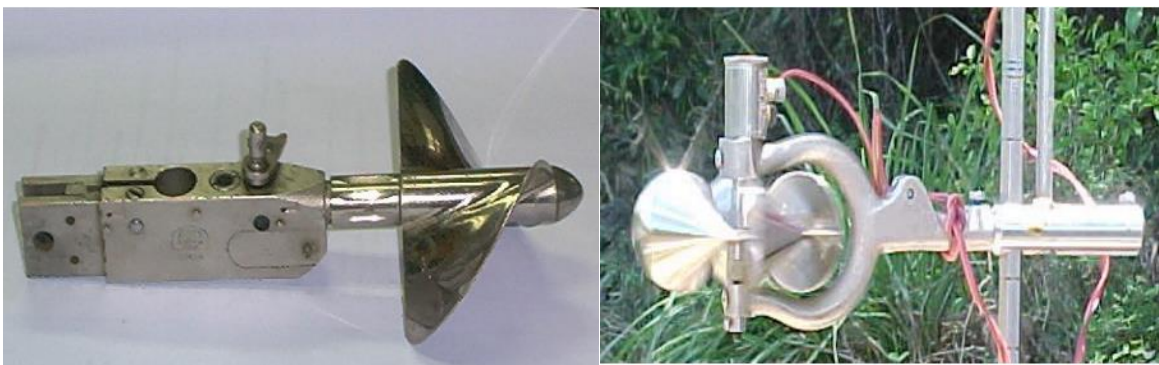
Figura 5 - Da esquerda para direita: molinete de eixo horizontal e de eixo vertical, adaptado de Cidreira (2014)
