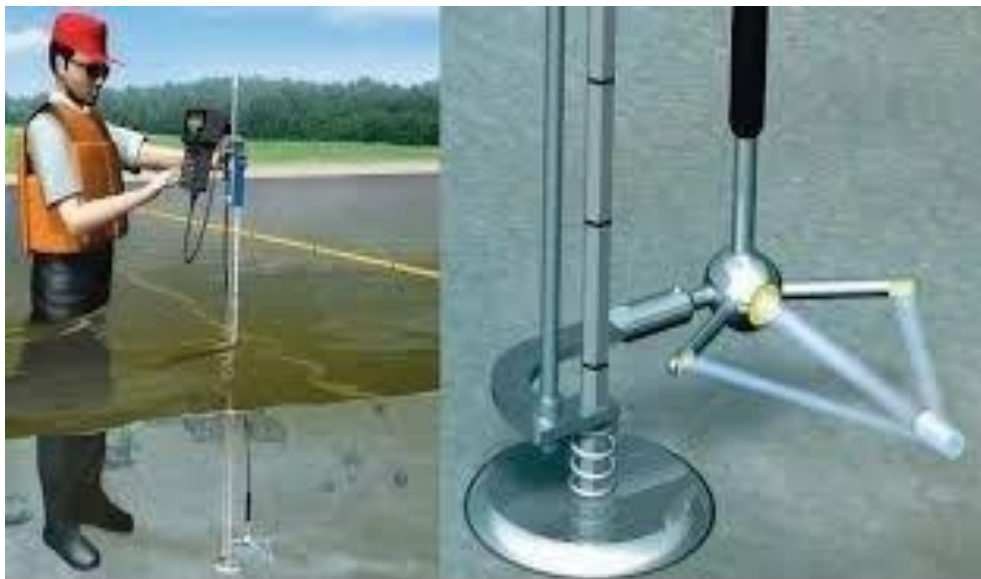
Figura 17 – ADV modelo Flowtracker , adaptado de Sontek (2007)
