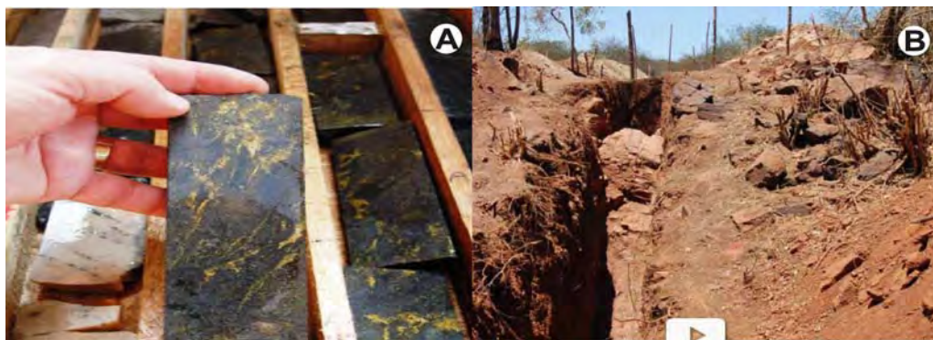
Figura 6 - Aspectos de campo do depósito de cobre de Serrote da Laje. A) calcopirita disseminada em hiperstenito; B) aspectos das rochas máfico-ultramáficas no campo. Extraído de Aura Mineral Resources (2010).
