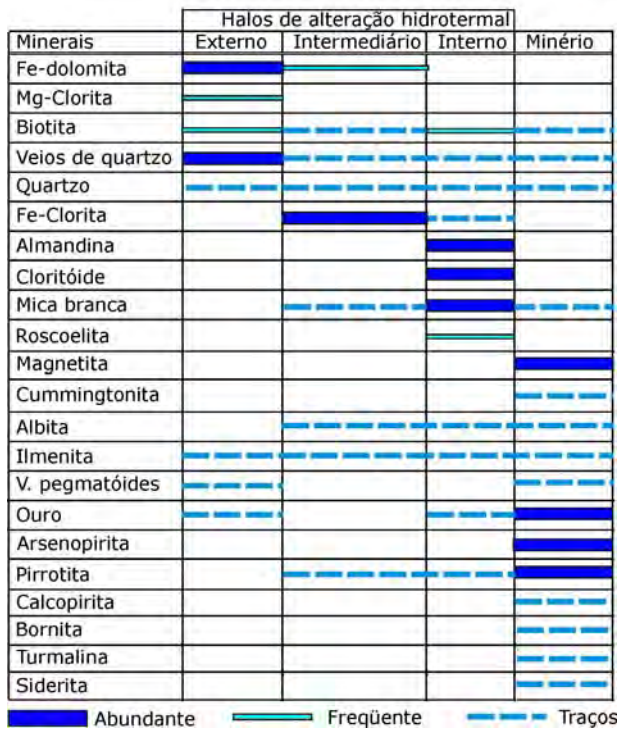
Figura 6 – Associações minerais dos halos de alteração hidrotermal metamorfizados que envelopam corpos de sulfeto maciço de Crixás. Dados compilados de Fortes (1996), Jost (2004) e Oliver et al. (2005).
