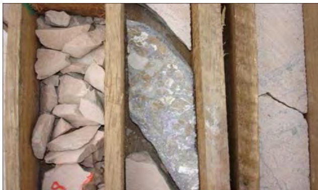
Figura 13 – Brecha de falha mineralizada a galena e esfalerita (centro) em arenitos hidrotermalizados com alguma mineralização disseminada (direita). Testemunho de sondagem do Depósito Santa Maria, RS.
