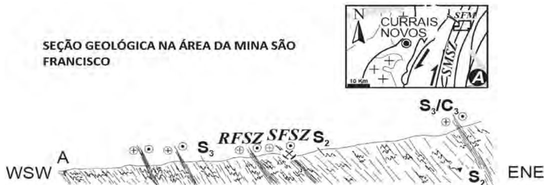
Figura 11 - Seção geológica na área da mina São Francisco (SFM na caixa superior direita), segundo Araújo et al. (2001). Siglas das zonas de cisalhamento: RFSZ – Riacho dos Freires; SFSZ – São Francisco.
