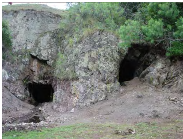
Figura 14 – Galerias de pesquisa abertas conforme o filão principal, em arenitos, conglomerados e andesitos (Cerro dos Martins, RS).
