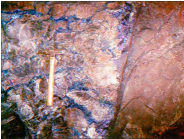
Figura 9 – Frente de lavra do nível 180 mostrando brecha cimentada por calcosita (Mina Uruguai subterrânea, minas do Camaquã, RS).
