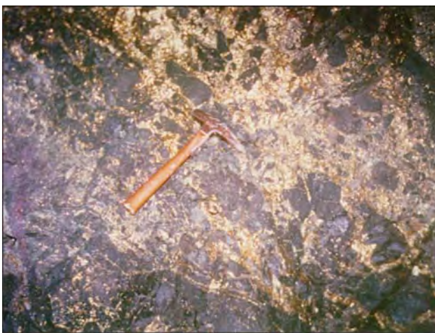
Figura 10 – Frente de lavra do nível 220 mostrando brecha cimentada por calcopirita e pirita (Mina Uruguai subterrânea, minas do Camaquã, RS).
