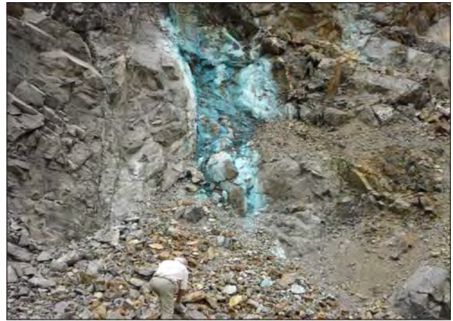
Figura 11 – Detalhe da Figura 8; oxidação superficial do minério sulfetado de cobre na Mina a céu aberto Uruguai (minas do Camaquã, RS).
