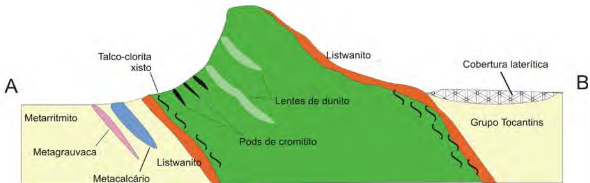
Figura 6 – Mapa geológico do Complexo Quatipuru apresentando as principais áreas de ocorrência de cromititos, além de seção tipo esquemática do complexo, que mostra o envelope de listwanito que proporciona sustentação da serra. Modificado de Paixão (2009).
