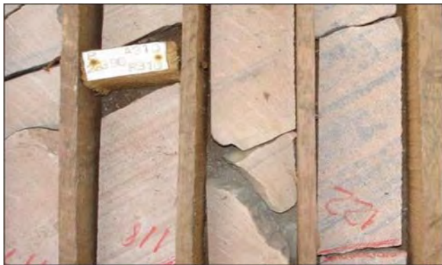
Figura 12 – Disseminações de galena e esfalerita no acamamento de arenito. Testemunho de sondagem do Depósito Santa Maria, RS.
