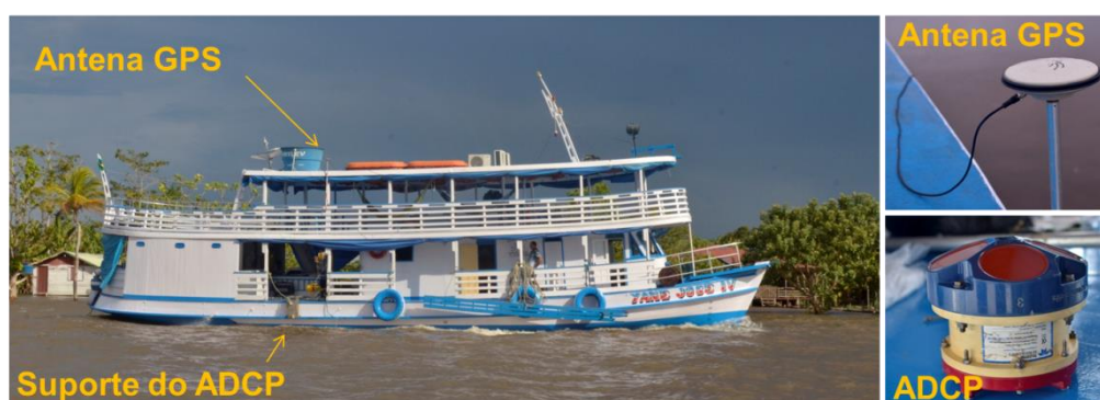
Figura 3.2. Esquema de medição de vazão utilizando o ADCP acoplado a uma grande embarcação e sistema de GPS
