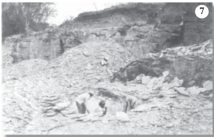
Figura 7 – Exploração artesanal dos calcários laminados (unidade carbonatada C6, Figura1) do Membro Crato da Formação Santana. Afloramento na altura do km 4-5, da rodovia C-255, entre as cidades de Nova Olinda e Santana do Cariri. Na foto, observa-se os entulhos deixados após a seleção das melhores placas, que são comercializadas.
