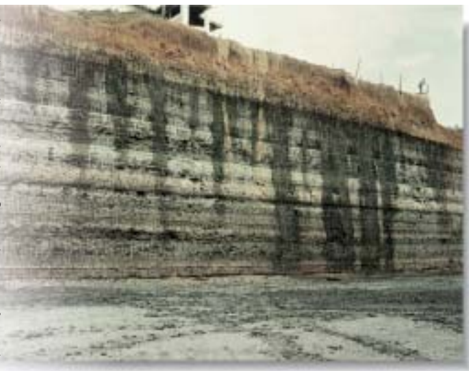
Figura 7 - Frente de exploração na Extrativa Santa Fé, em 1993, São observados os diferentes níveis de folheto pirobetuminoso e argilitos-siltosos, tendo na base a argila esmectícia.
