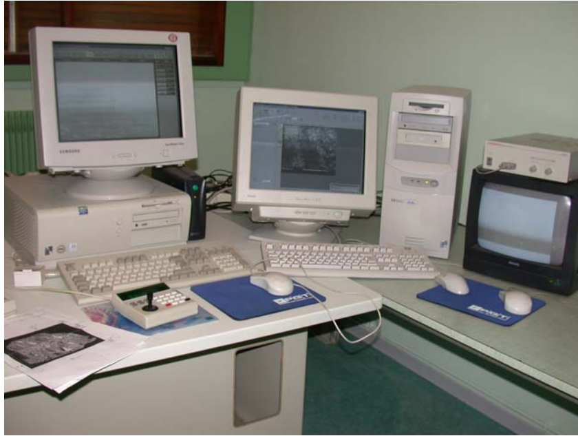
Figura VI.4 - Detalhe do sistema EBSD acoplado ao microscópio eletrônico de varredura mostrando os microcomputadores e a platina motorizada.
