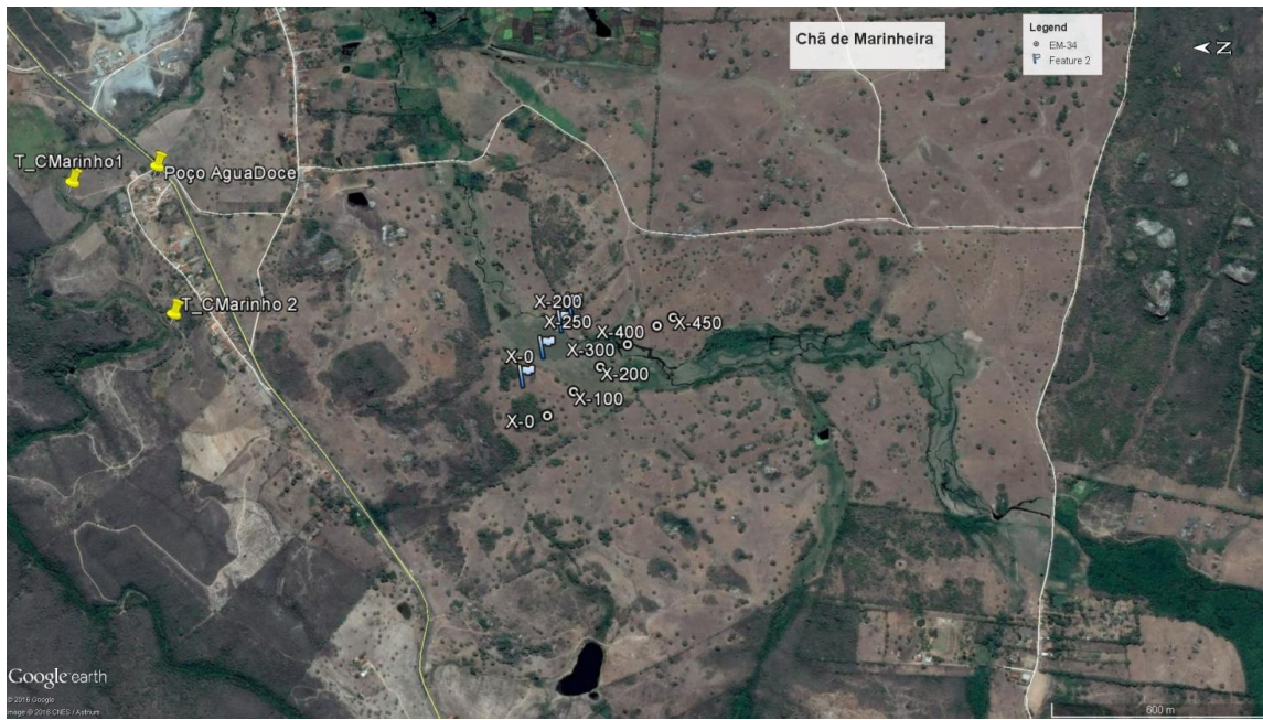
Figura 4.21 - Localidade de Chã do Marinheiro e os caminhamentos executados com os equipamentos EM-34 (a leste) e com o PROMIS (a oeste). Notar a drenagem condicionada por fraturas diversas.
