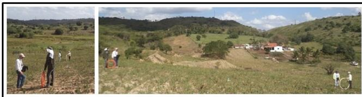
Figura 4.26 - Equipe de campo na execução de levantamento eletromagnético com Geonics EM34-3XL (dipolo horizontal) na zona rural de Campina Grande, próximo ao Bairro Novo Bodocongó.
