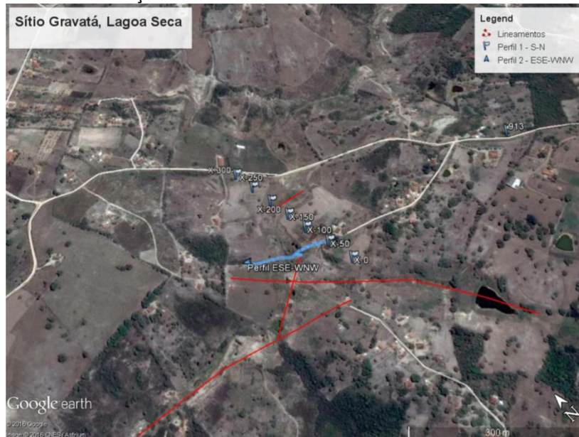
Figura 4.11 - Imagem Google Earth do Sítio Gravatá em Lagoa Seca. Perfil 1 identificado pelas estações de medida e o Perfil 2 em linha azul. Lineamentos em vermelho.
