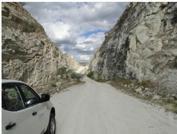
Figura 46 - Vista da cava da mina do Mármore Santa Rosa. A cava é desenvolvida linearmente devido à influência da Zona de Cisalhamento São João do Cariri, que verticalizou as camadas de mármore.
