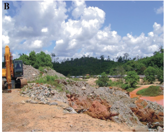
Figura 6.9 - Processos de lavra garimpeira dos materiais de rejeito da Mina de Salamangone: (A) por desmonte hidráulico, e (B) com a utilização de máquinas escavadeiras, caminhões e moinhos.
