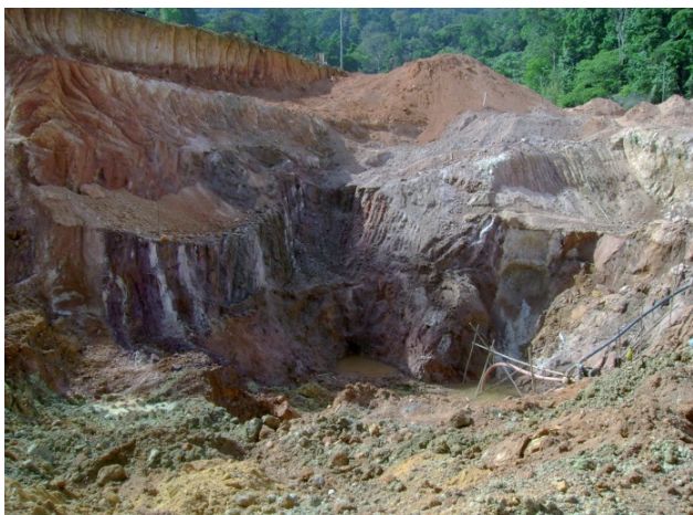
Figura 6.13 - Cava de garimpo em saprólito no garimpo do Português, com zonas arroxeadas e esbranquiçadas (cauliníticas), verticalizadas.
