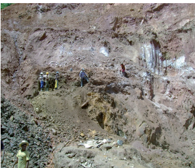
Figura 6.11 - Lavra a céu aberto em área da antiga Mina de Yoshidome. Notar zonas esbranquiçadas (caulíníticas) de dimensões métricas.
