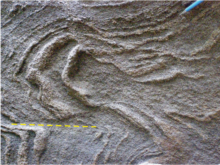
Figura 4.3 - Bandamento composicional dobrado. Notar superfície plano axial, marcada pela linha amarela pontilhada
