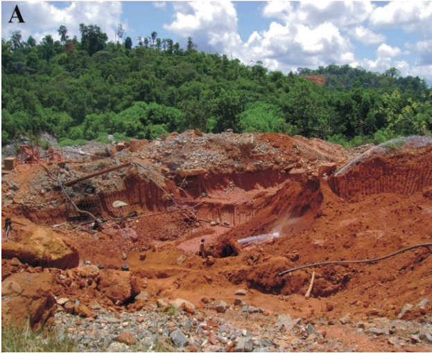
Figura 6.9 - Processos de lavra garimpeira dos materiais de rejeito da Mina de Salamangone: (A) por desmonte hidráulico, e (B) com a utilização de máquinas escavadeiras, caminhões e moinhos.
