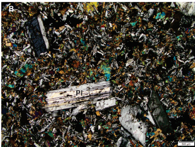
Figura 3.57 - Texturas comuns nos diabásios. (A) Ofítica e subofítica. Notar cristais de clinopiroxênio englobando ripas de plagioclásio. Amostra LM-R-05. (B) Microporfirítica, com fenocristais de plagioclásio em matriz fina subofítica. Amostra MC-R-27.PI - Plagioclásio, Cpx - Clinopiroxênio.
