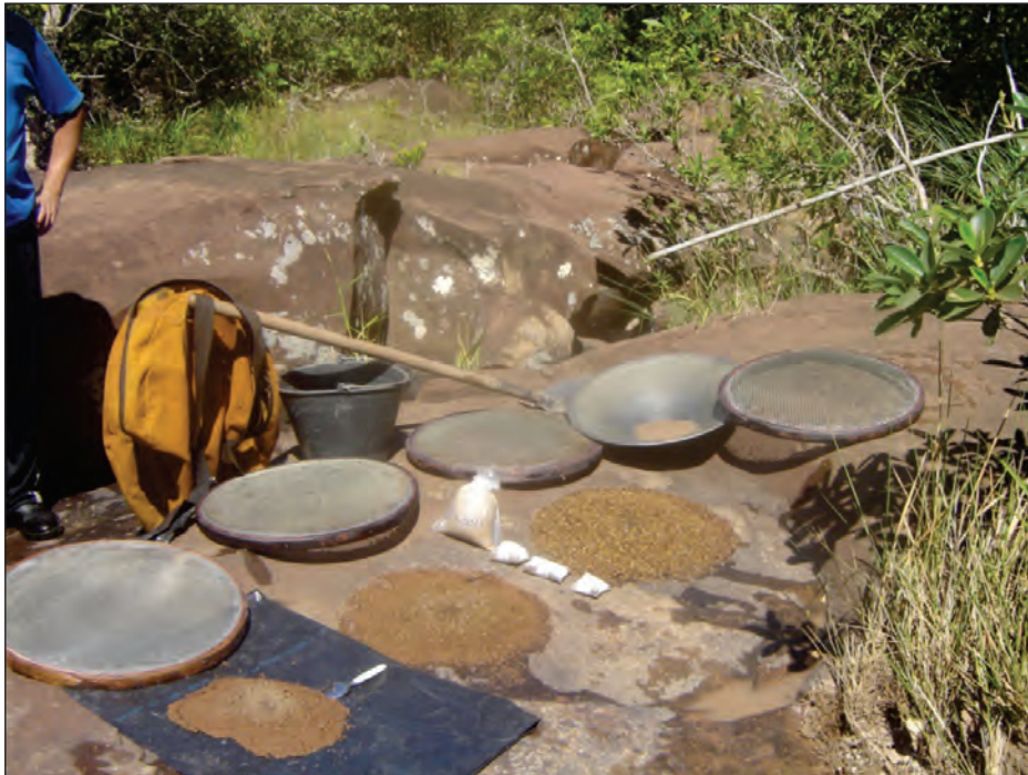
Figura 5.4 – Detalhe do jogo de peneiras e bateia utilizadas na amostragem aluvionar e concentrado de bateia.
