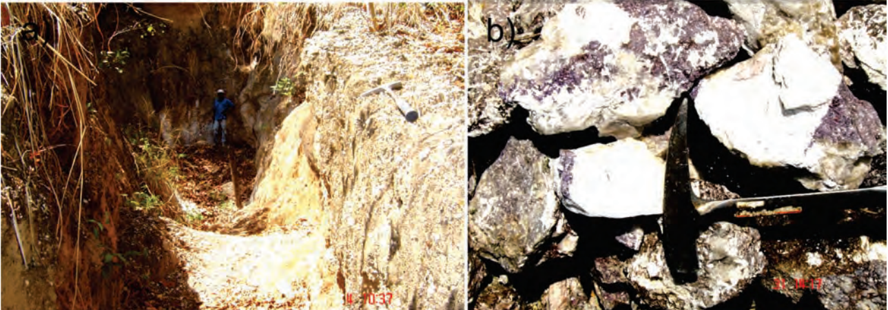
Fotografia 7.20 – a) Trincheira de acesso à galeria (obstruída) de exploração do garimpo proximal da Fazenda Jataí; b) Pilha de rejeito do pegmatito proximal e blocos de feldspato, mica liláz e quartzo.
