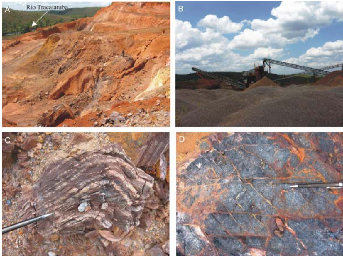
Figura 7.3 – (A) Vista geral e (B) planta de beneficiamento da mina de ferro do Rio Tracajatuba; (C) Dobra em formação ferrífera; (D) Aspecto do minério de ferro intensamente fraturado.
