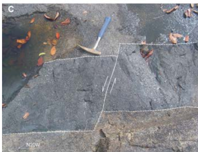
Figura 5.6 - Evidências da tectônica rúptil na Folha Rio Araguari. (A) Sistema de fraturas subparalelas de direção N20W. Estação LT-84; (B) Juntas de dilatação escalonadas de direção N20E preenchidas por quartzo. Estação LT-211; (C) Dique básico (Diabásio Cassiporé) N20W seccionado por falha sinistral N70E. Estação LT-184.
